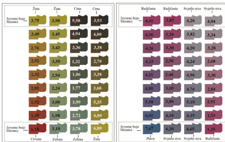
Slika 8.28. \Delta E novih boja blizanaca, bojila CMYF n , otisak na mat kustdruck papiru 115 g/m 2
