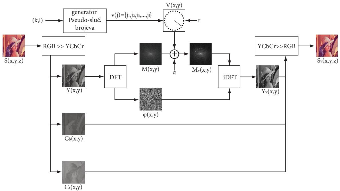
Slika 19. Koder sustava za označavanje slika.
