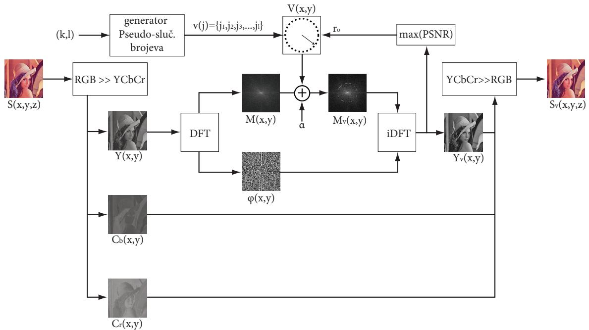
Slika 28. Blok dijagram modificiranog kodera
