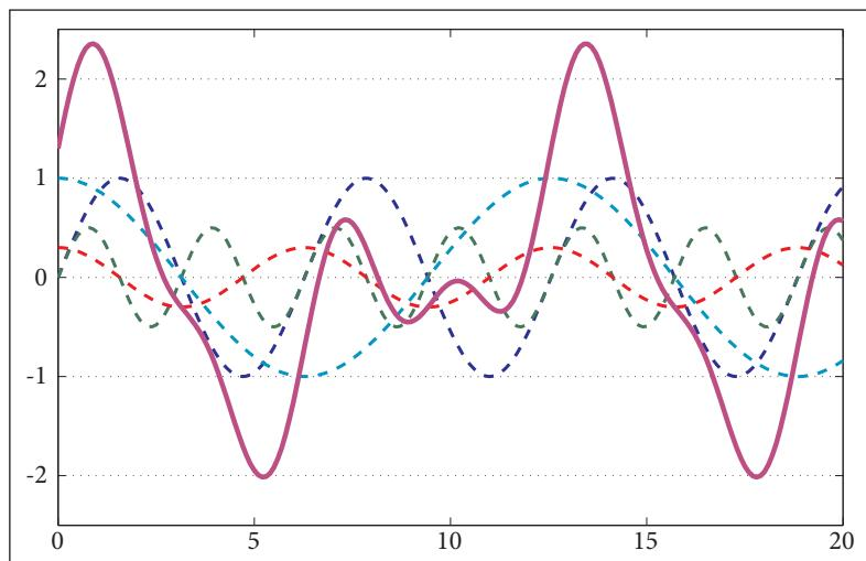
Slika 10. Originalni signal (čvrsta linija) i spektar signala različitih frekvencija dobiven Fourierovom transformacijom (iscrtane linije)
