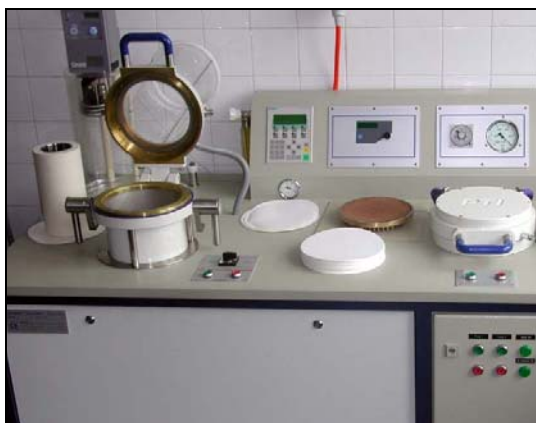
Slika 35. Rapid Köthen uređaj za izradu laboratorijskih listova recikliranih papira
