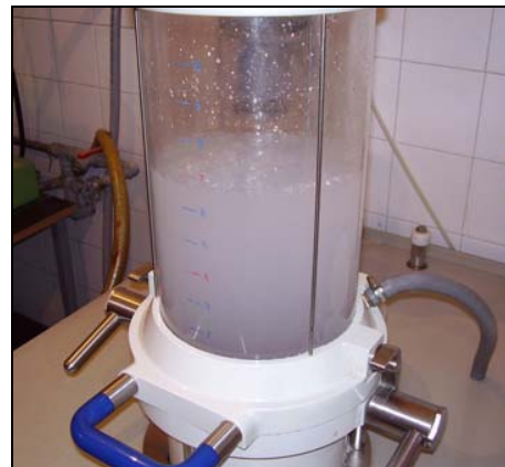
Slika 35. Rapid Köthen uređaj za izradu laboratorijskih listova recikliranih papira
