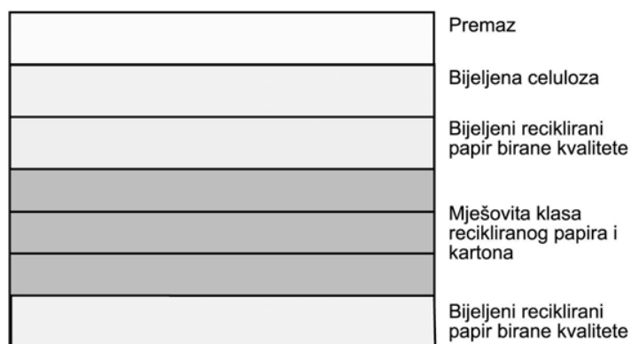
Slika 13. Shematski prikaz kromokartona (Kirwan, M.J., 2005)
