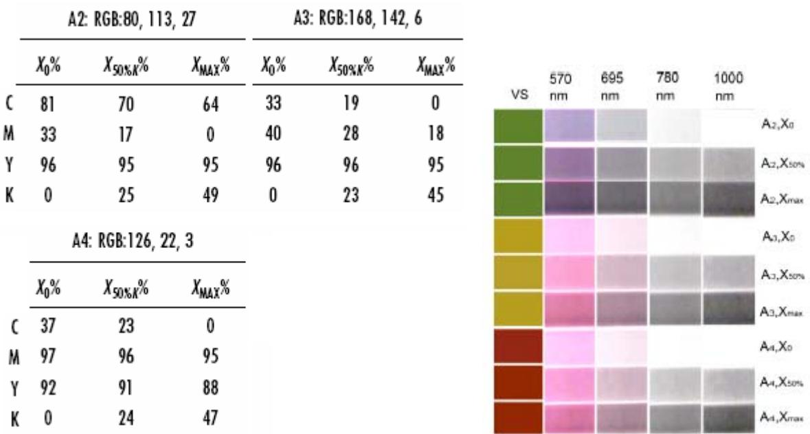
Slika 99. Skanirane boje A2, A3 i A4 u ovisnosti o valnim duljinama, otisnute Xeikon digitalnim tiskarskim strojem (izvor: 21, Pap, Žiljak, *et al.*, pp 010502-4, slika 4-dio i tabela 1-dio)
