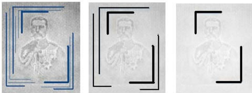
Slika 81. Prijedlog kombiniranja vodenog znaka i infracrvenih boja. Dnevno svijetlo i infracrveno zračenje od 850 i 1000 nm
