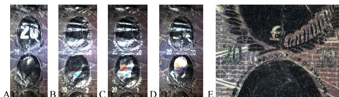
Slika 48. Reprodukcija holograma na krivotvorenoj novčanici od 20 britanskih funta , uvećanje 7,4 puta. Ring skaniranje (A,B,C,D) i detalj uvećan 29 puta, imitacija bijelog svjetla (E).
