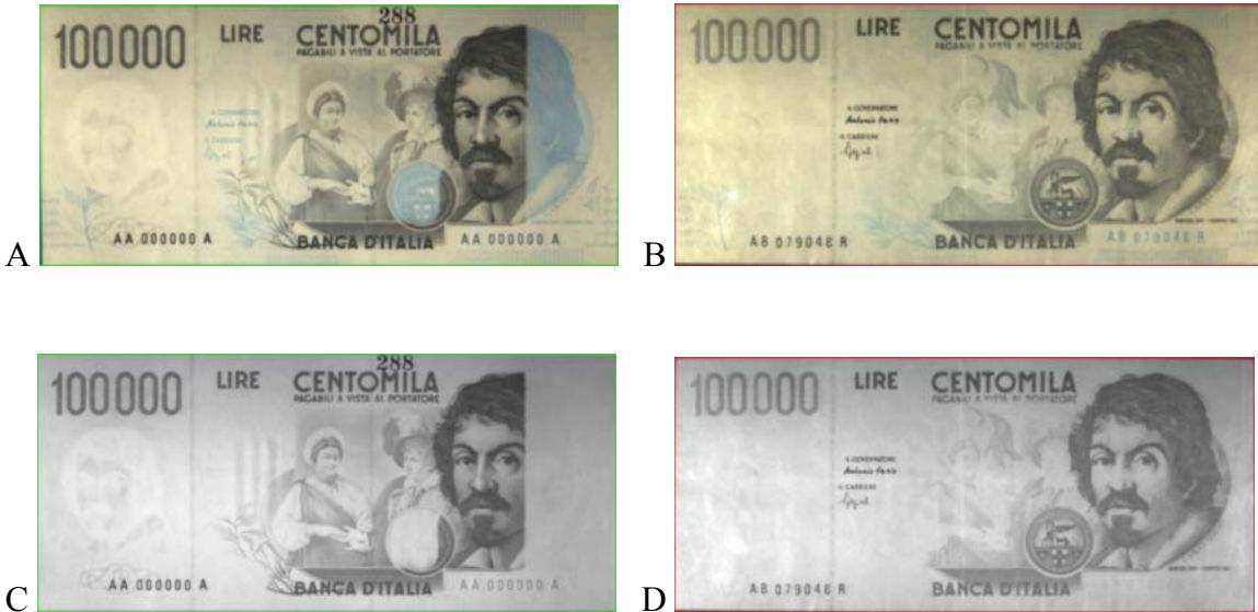
Slika 67 Komparacija odaziva boja pod infracrvenim zračenjem originalne novčanice od 100 000 lira i krivotvorine. IR zračenje od 735 nm, original (A), krivotvorina (B). IR zračenje od 830 nm, original (A), krivotvorina (B).
