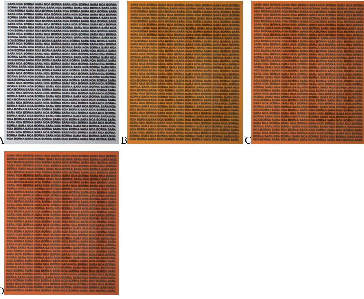
Slika 101 Transformacija informacije u ovisnosti o valnim duljinama, imitacija bijelog svjetla (A), 570 nm (B), 590 nm (C), 610 nm.
