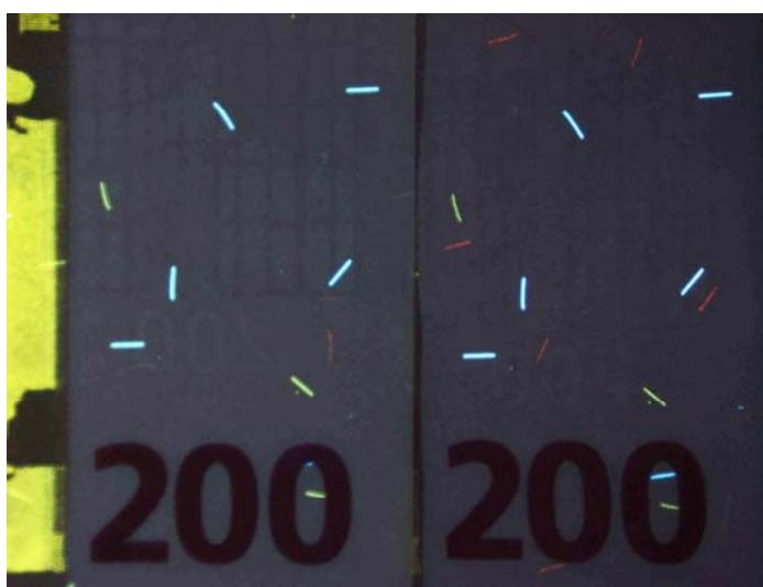
Slika 66 Istovremena komparacija detalja krivotvorina indikativa 200 P3 broj 45 i 46 pod UV svjetлом od 365 nm, uvećanje 5.9
