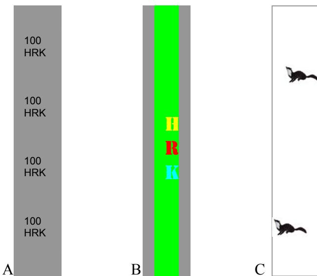
Slika 91. Prijedlog zaštitne niti pod propusnim (A), UV (B) i IR svjetлом (C)
