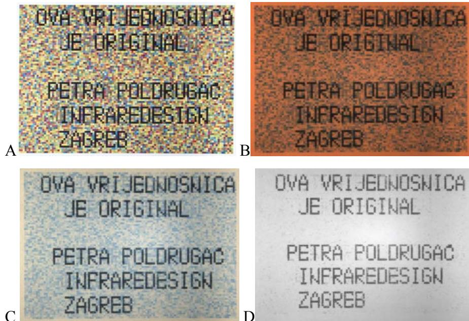
Slika 110 Imitacija objekta pod bijelim svjetлом (A), 630 nm (B), 715 nm (C) i 830 nm (D).
