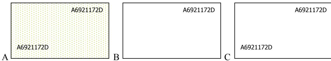
Slika 97. Prijedlog skrivene numeracije pod vidljivim svjetлом (A), IR svjetlom od 830 nm (B) i očekivana imitacija (C)
