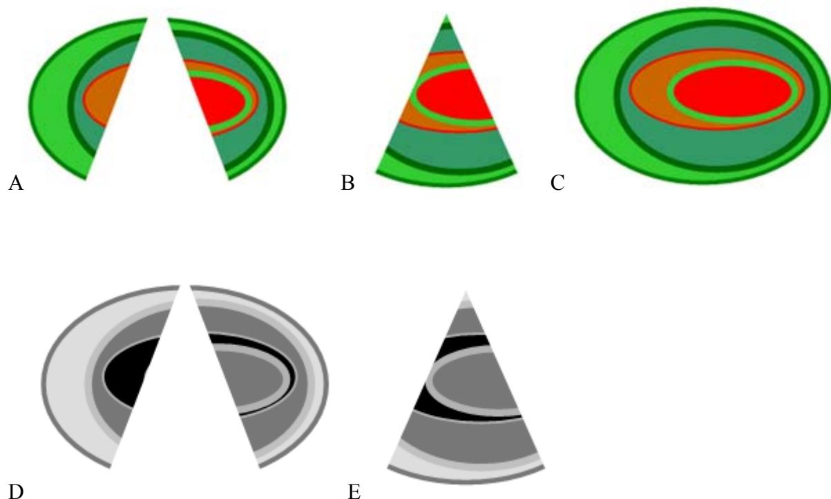
Slika 82. Prijedlog prozirnog registra sa kontroliranim odazivom u IR spektru. Segmenti na licu novčanice (A), segmenti na naličju novčanice (B), bijelo svjetlo. Prozirni register pod propusnim svjetlom (C) i odaziv segmenata na licu (D) i naličju (E) pod IR svjetlom od 850 nm.
