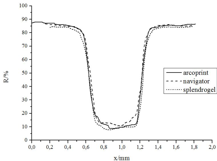
Slika 142. Epson Stylus Pro 7000 - reflektacijski profil 0,5 mm
