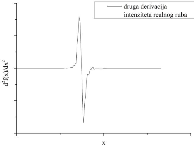
Slika 49. Laplasijan slike realnog ruba prikazanog na slici 46.
