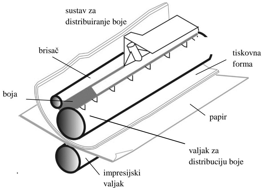
Slika 37. Konstrukcija riso uređaja za propusni tisak [9]
