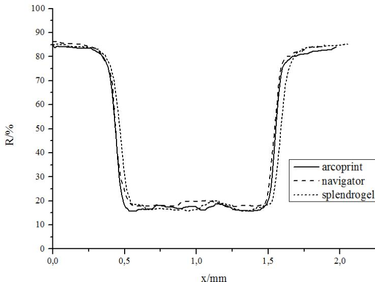
Slika 148. Epson Stylus Photo 2400- reflektancijski profil 1 mm
