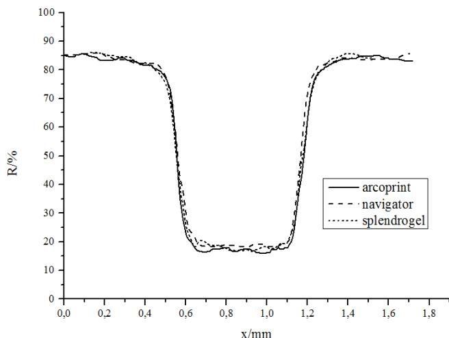
Slika 151. Epson Stylus Photo 2400- reflektancijski profil 0,5 mm
