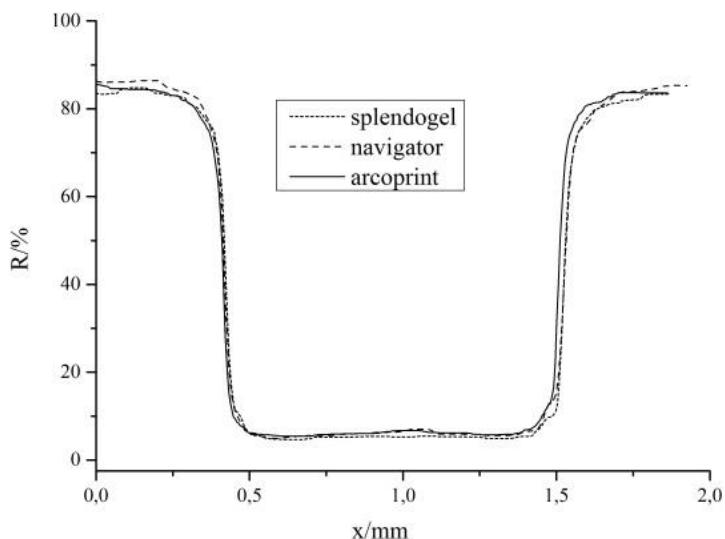
Slika 130. Indigo Turbo Stream - reflektancijski profil 1 mm
