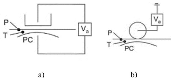
Slika 26. Prijenos tonera sa fotoosjetljive površine na papir<sup>[33]</sup> (P-papir, T-toner, PC-fotoosjetljiva površina)
