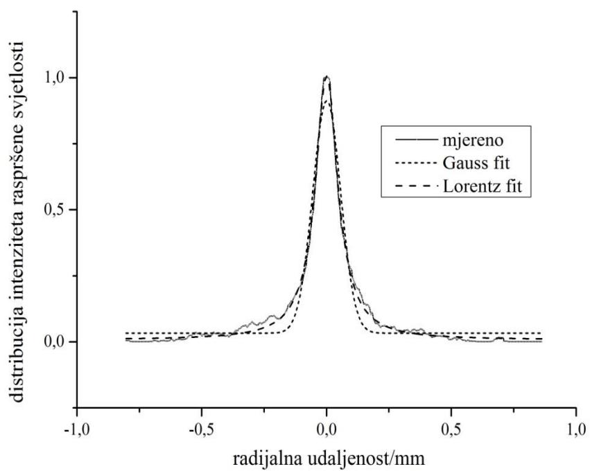
Slika 59. Optički dio PSF - Arcoprint  $120 \text{ g/m}^2$
