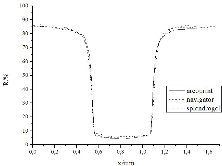
Slika 115. HP 9050 Laser Jet - reflektacijski profil 0,5 mm
