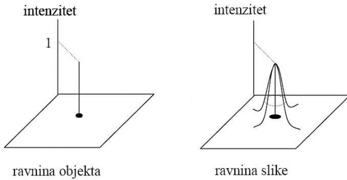
Slika 41. a) Digitalni original-točasti izvor jediničnog intenziteta, b) otisak-idealna slika točkastog izvora (*PSF*)<sup>[88]</sup>
