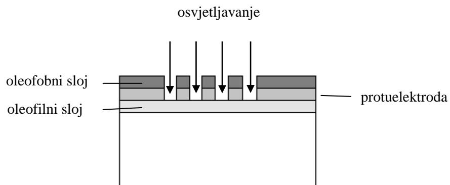
Slika 35. Princip generiranja tiskovne forme prve generacije uređaja za direktno osvjetljavanje<sup>[9]</sup>
