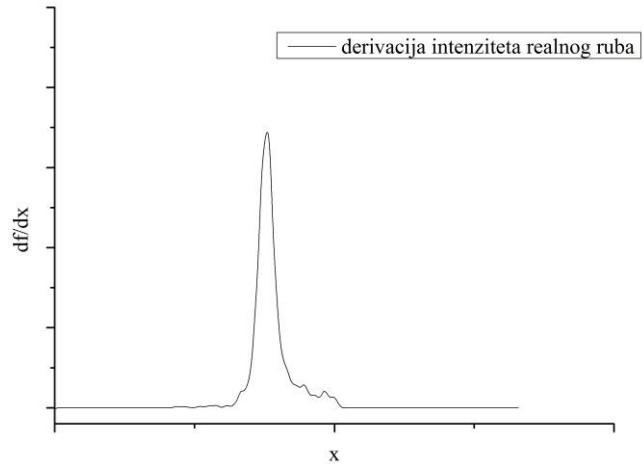
Slika 48. Gradijent slike realnog ruba prikazanog na slici 46.
