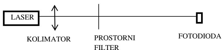
Slika 54. Eksperimentalni postav za određivanje laserskog profila
