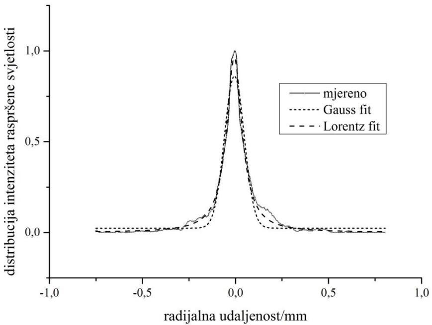
Slika 60. Optički dio PSF - Splendorgel  $115 \text{ g/m}^2$
