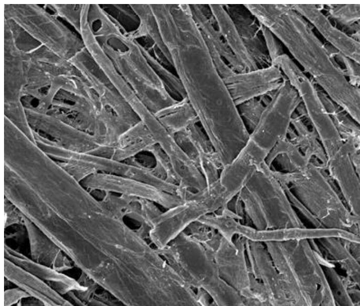
Slika 2. Slika površine papira snimljene elektronskim mikroskopom (SEM) [1]
