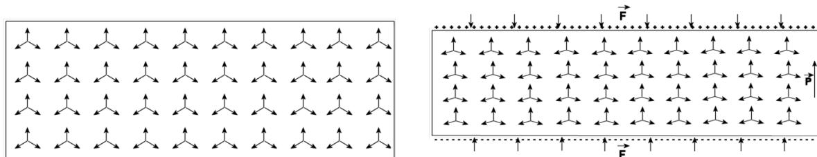
Slika 29. a) nedeformirani kristalni piezoelektrik      b) deformirani kristalni piezoelektrik
