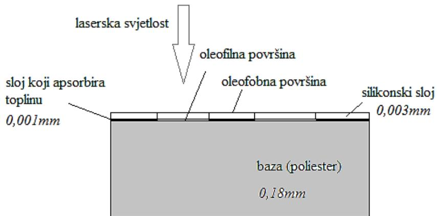
Slika 36. Princip generiranja tiskovne forme laserskom ablacijom
