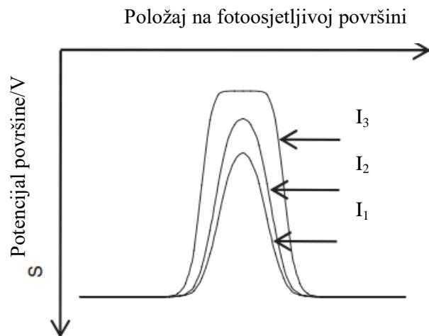
Slika 20. Ovisnost potencijala površine o intenzitetu upadne svjetlosti (intenzitet upadne svjetlosti raste od  $I_1$  prema  $I_3$ )<sup>[25]</sup>
