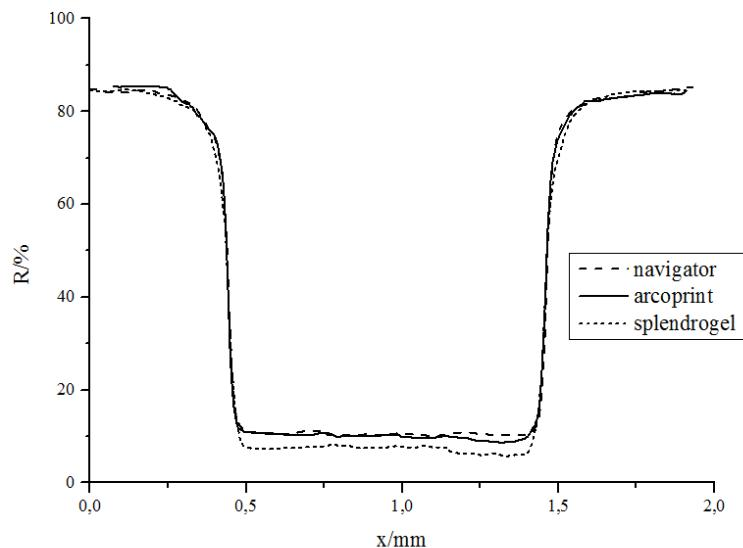
Slika 67. Heidelberg quickmaster- reflektacijski profil 1 mm
