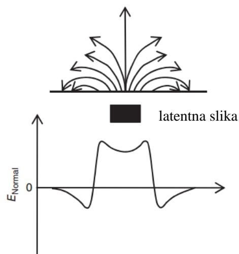
Slika 21. Električno polje iznad osvijetljenog dijela<sup>[18]</sup>
