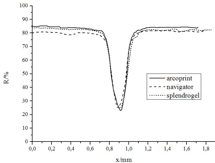
Slika 145. Epson Stylus Pro 7000 - reflektancijski profil 0,1 mm
