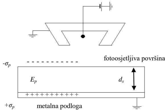
Slika 10. Shematski prikaz korotrona<sup>[18]</sup>
