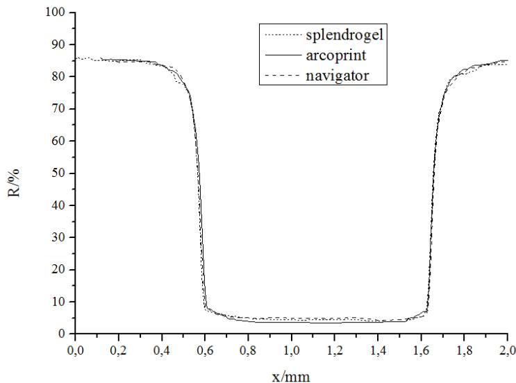
Slika 112. HP 9050 Laser Jet - reflektancijski profil 1 mm
