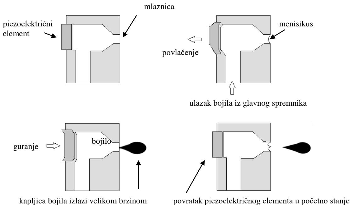
Slika 32. Princip rada Epsonove Micro Piezo ispisne glave
