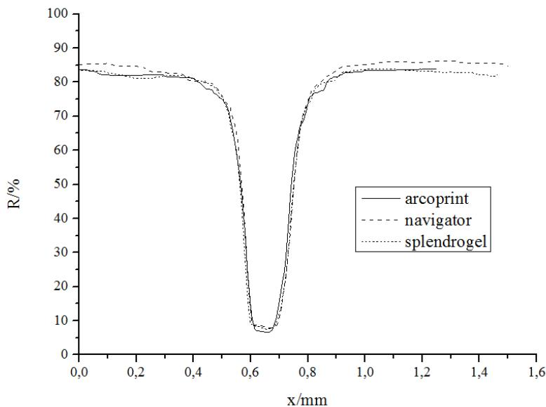
Slika 118. HP 9050 Laser Jet - reflektancijski profil 0,1 mm
