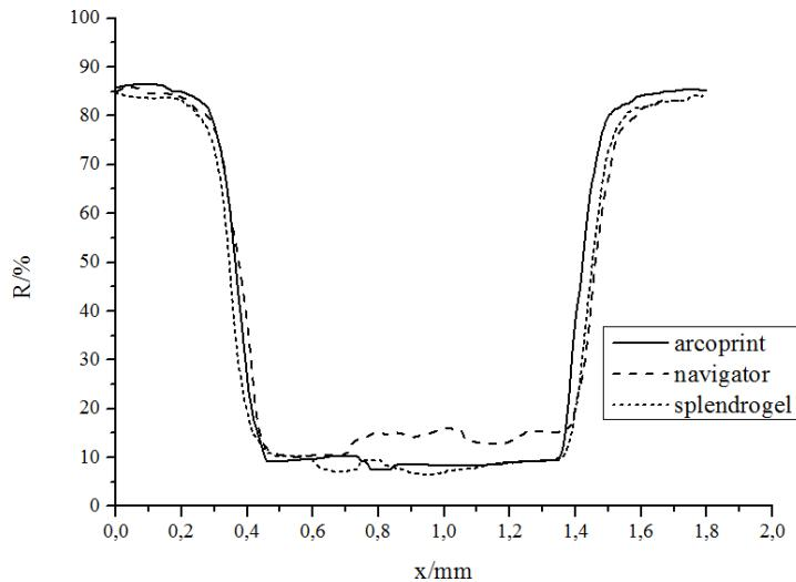
Slika 139. Epson Stylus Pro 7000 - reflektancijski profil 1 mm
