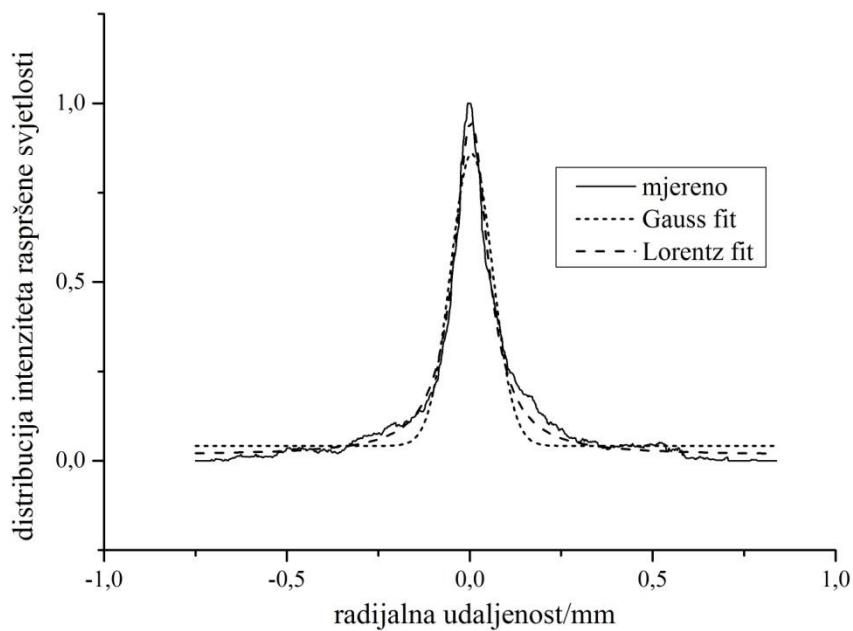
Slika 61. Optički dio PSF - Navigator  $80 \text{ g}/\text{m}^2$
