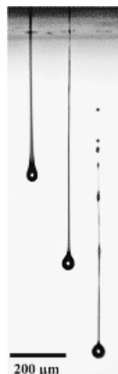
Slika 33. S lijeva na desno: formiranje kapljice, odvajanje od mlaznice, stvaranje satelitskih kapljica [63]
