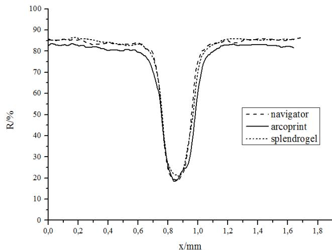
Slika 154. Epson Stylus Photo 2400 - reflektancijski profil 0,1 mm
