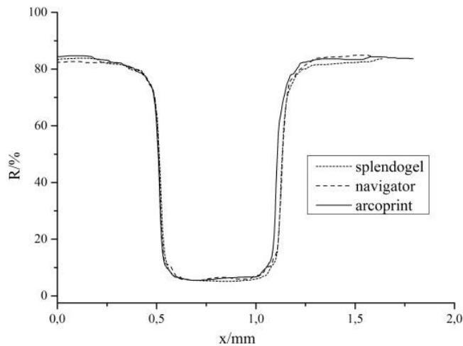
Slika 133. Indigo Turbo Stream - reflektancijski profil 0,5 mm
