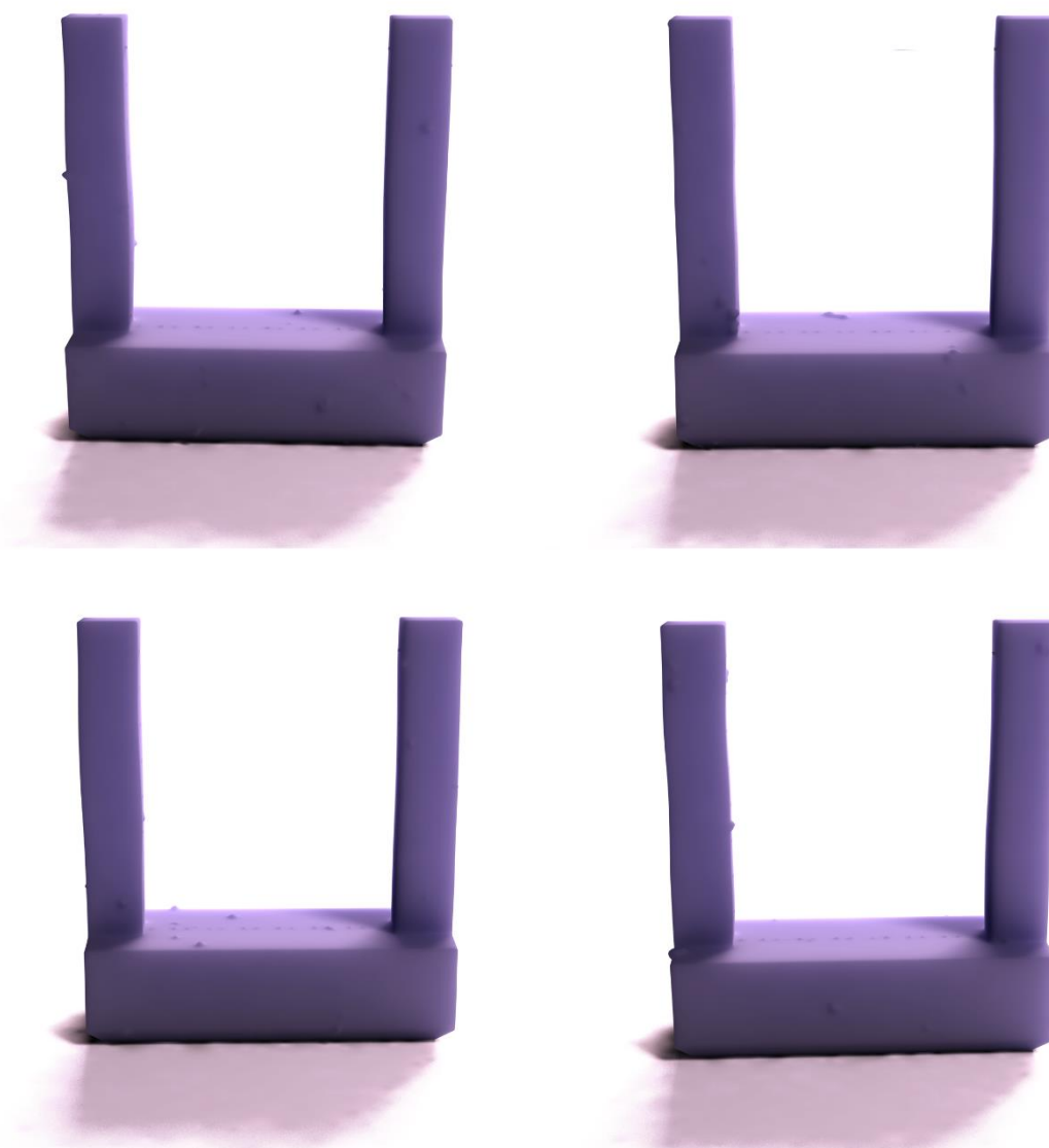
Slika 32. Modeli debljine spona 0.1 mm
