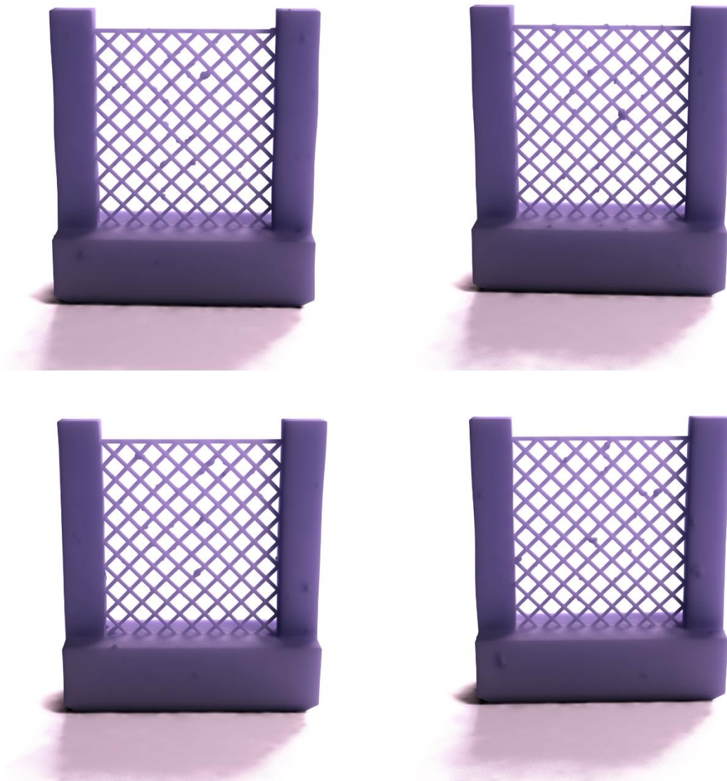
Slika 36. Modeli debljine spona 0.3 mm
