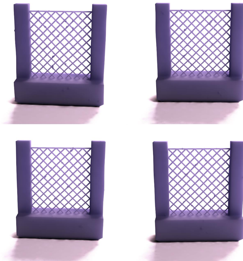
Slika 35. Modeli debljine spona 0.25 mm
