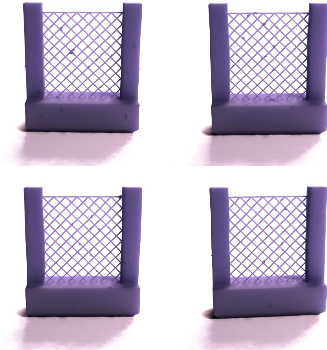
Slika 34. Modeli debljine spona 0.2 mm
