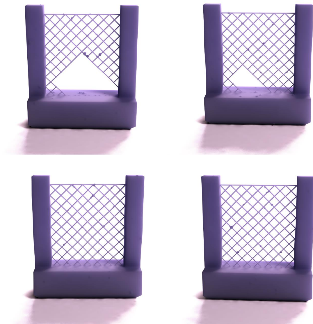
Slika 33. Modeli debljine spona 0.15 mm
