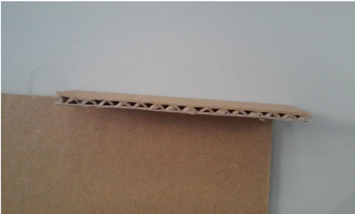
Slika 9. Pravilno ulaganje epruvete za testiranje
