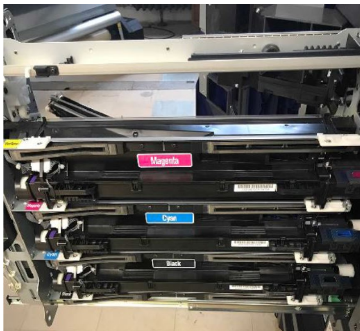
Slika 8 Razvijačka jedinica Konica Minolte AccurioPress C3070 (izvor: Majnarić, I. (2022.), Tečaj za operatere digitalnih strojeva)
