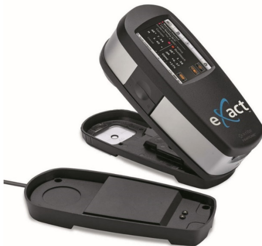
Slika 28. x-rite eXact Advanced spektrofotometar
