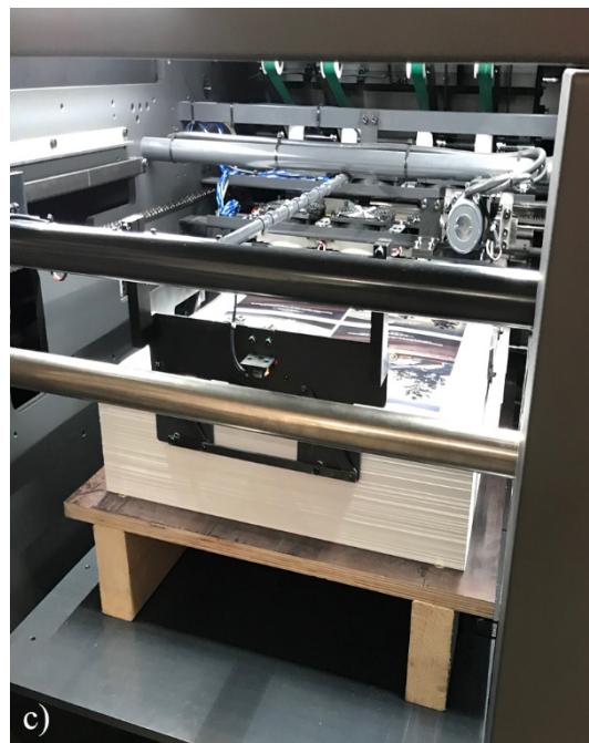
Slika 13. Transporta papira kroz stroj AccurioJet KM-1: a) putanja od predulaganja do izlaganja; b) centralni tiskovni cilindar; c) izlagači stol
