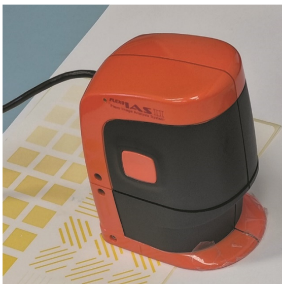
Slika 30. Digitalni mikroskop za slikovnu analizu Personal PIAS [Izvor: Autor fotografije: Sven Sabol]
