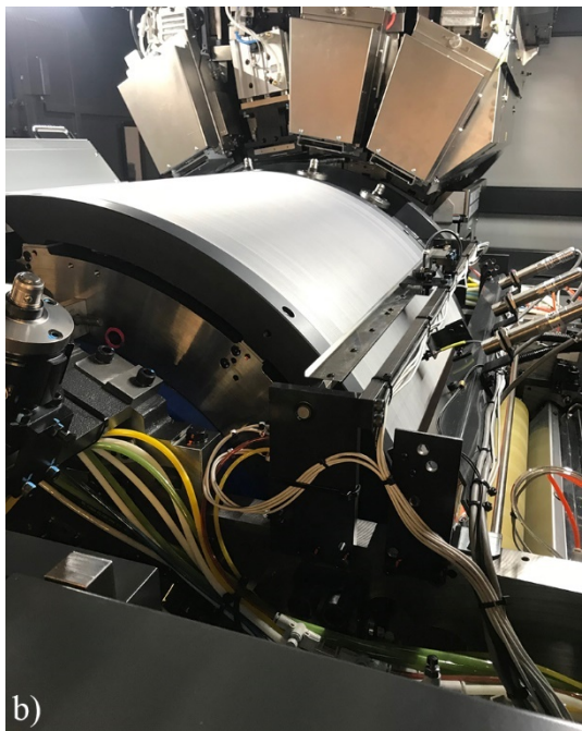
Slika 13. Transporta papira kroz stroj AccurioJet KM-1: a) putanja od predulaganja do izlaganja; b) centralni tiskovni cilindar; c) izlagači stol
