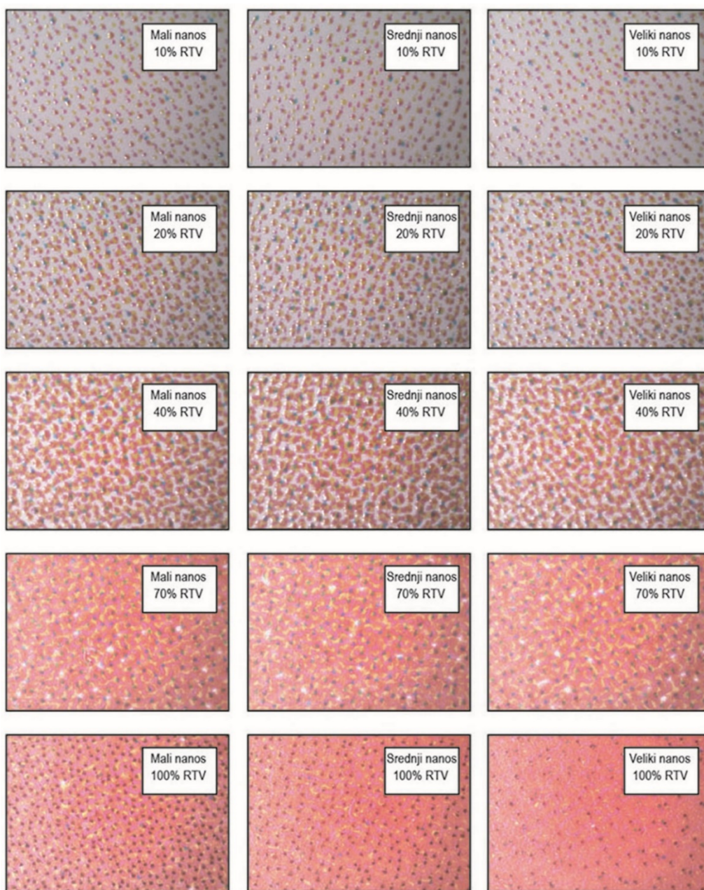
Slika 40. Uvećani prikaz od 167 puta mjerenih polja ostvarene varijacije nanosa žutog i magentnog Inkjet bojila
