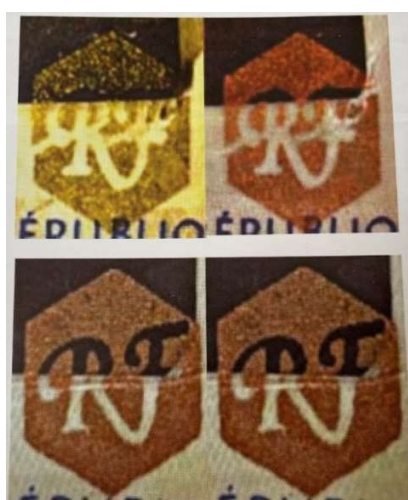
Slika 46. Izvoran OVI-element (gore) i njegova imitacija (dolje)
