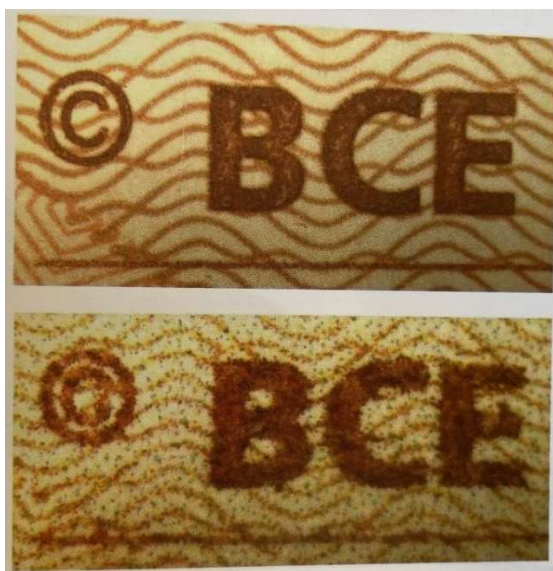
Slika 40. Izvorni dio novčanice otisnut offsetnim i intaglio-tiskom (gore) i krivotvoreni dio novčanice ispisan tintnim pisačem (dolje)
