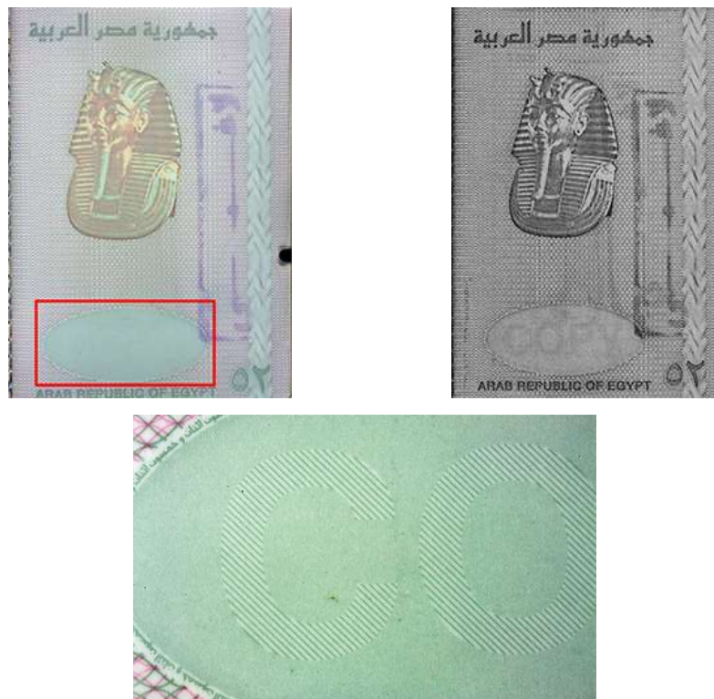
Slika 11. Egipatska putovnica s detaljima protukopirajućeg tiska
