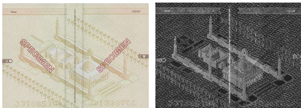
Slika 37. Putovnica u vidljivom (lijevo) i IR (desno) spektru
