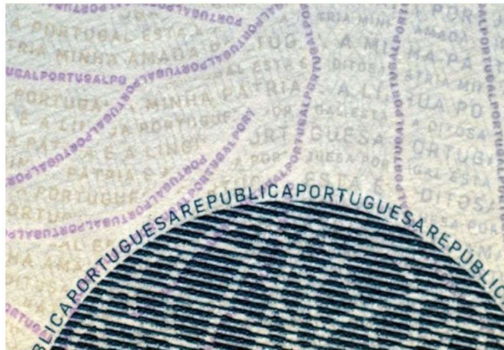
Slika 21. Minitisak (plavi tekst) i mikrotisak (ljubičasti tekst)
