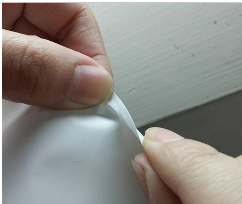
Slika 7 – otpornost sintetičkog papira na kidanje<sup>[23]</sup>
