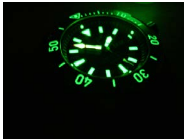
Slika 8 – Prikaz sata s detaljima premazanim radioluminiscენტnim slojem [32]
