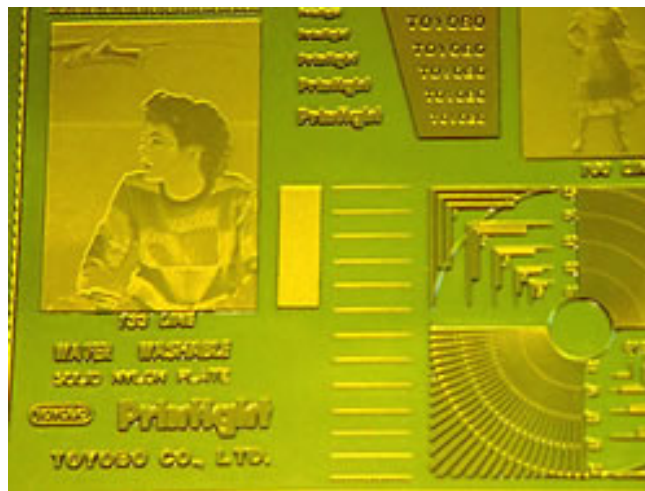
Slika 13 – prikaz polimerne tiskovne forme za fleksotisak [40]
