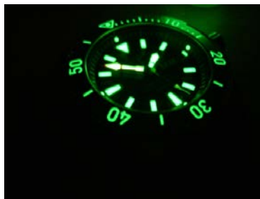
Slika 8 – Prikaz sata s detaljima premazanim radioluminiscentnim slojem [32]
