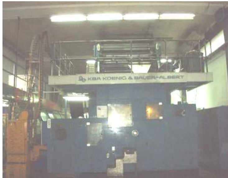
Slika 12. Prednji snimak KBA rotacije, nadgradnja i uređaj za savijanje
