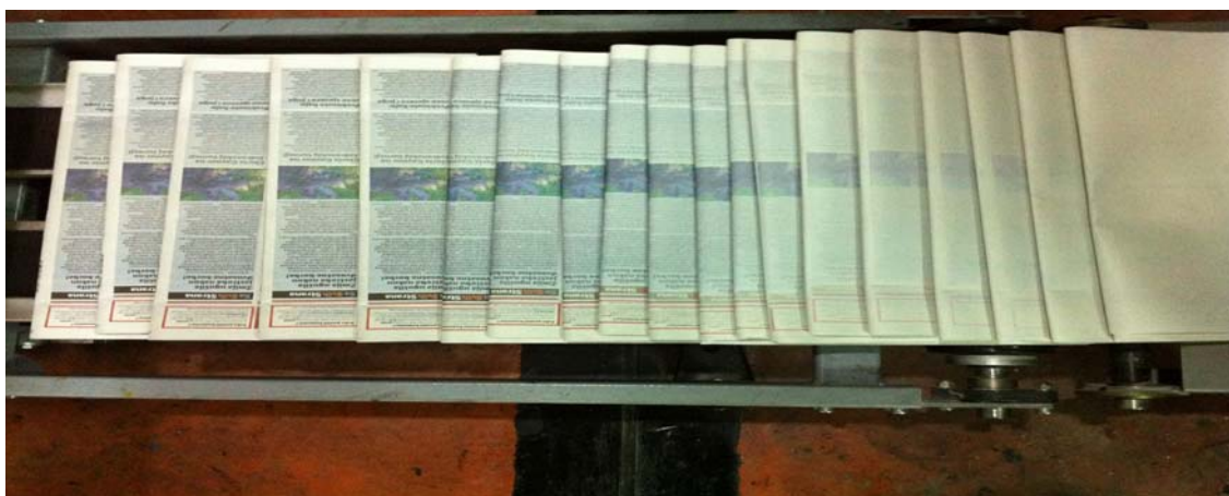
Slika 2. Prikaz slijeda novina od "bjele novine" do prvog prihvaćanja tiskarskog bojila na izlaznoj traci novinske ofset rotacije
