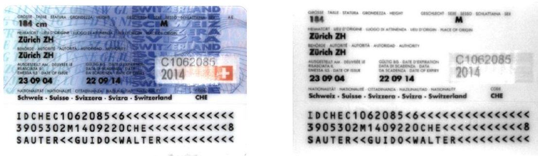
Slika 14: Kartica promatrana pri dnevnom svjetlu i pri IR izvoru svjetla
