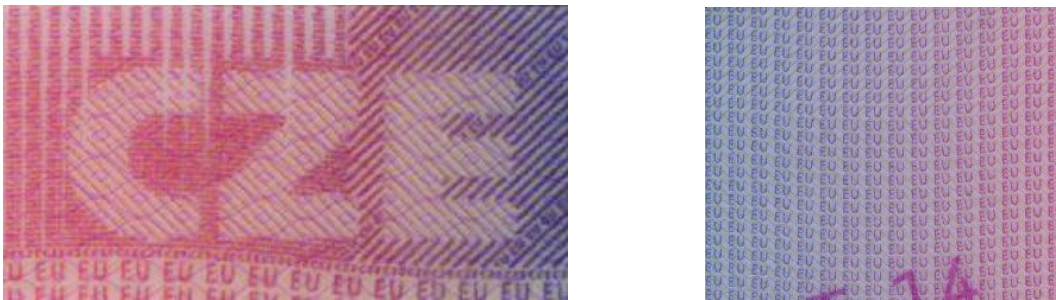
Slika 19: Iris tisak fine linijske grafike i teksta „EU“, kao osnovnog rasterskog elementa
