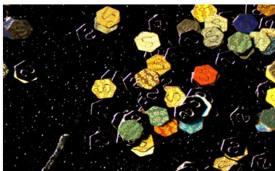
Slika 17: OVDot® čestice u polikarbonatnom arku za proizvodnju kartica
