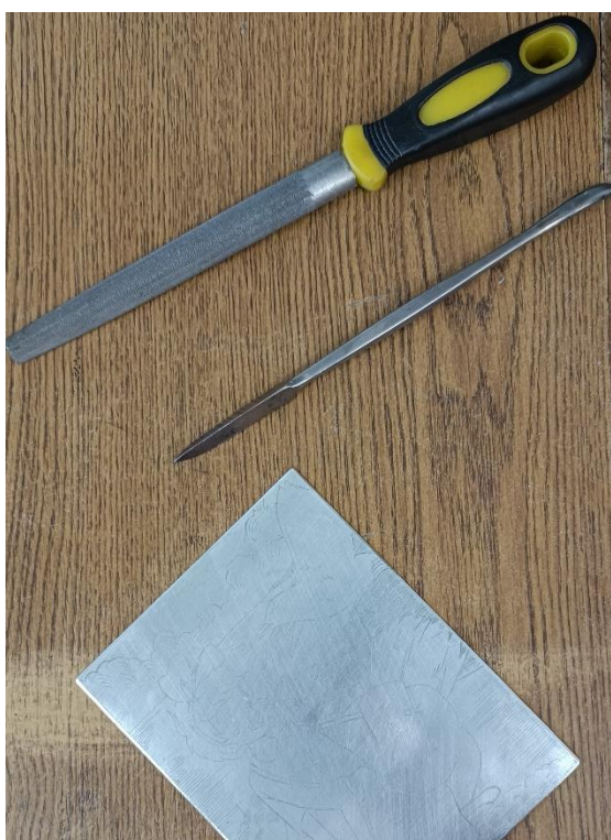
Slika 25 Alati za brušenje rubove i pravljenje faseta
