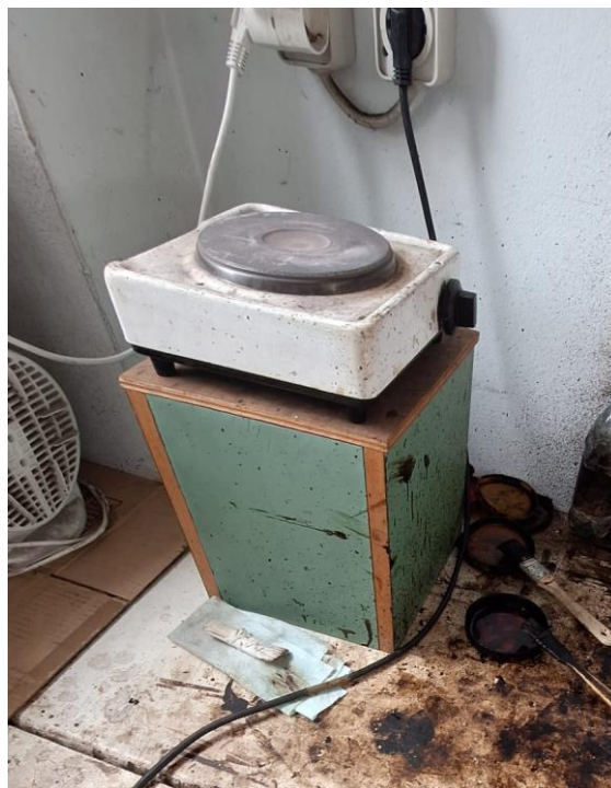
Slika 21 Pečica za pečenje nanesenog praha na pločici
