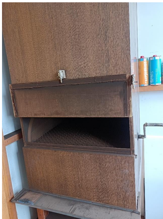
Slika 19 Ormar za stavljanje asfaltnog praha na pločicu
