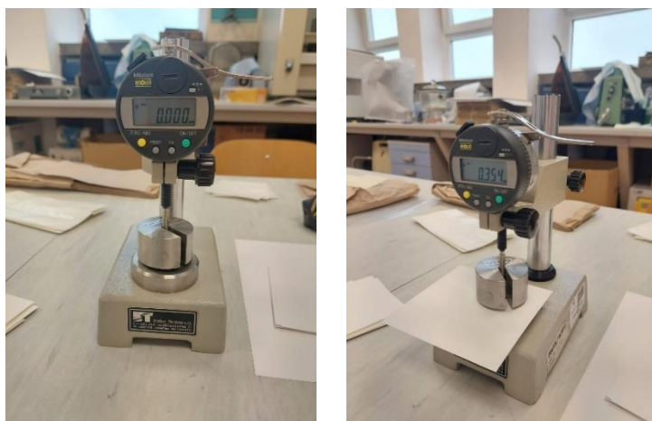
Slike 5. Mikrometar- uređaj za mjerenje debljine papira
