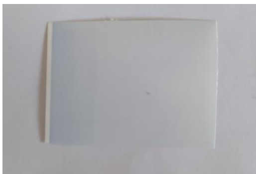
Slika 10 uzorak etikete od 15% vlakana otadnog grožđa otisnut reverzibilnom termokromnom bojom
