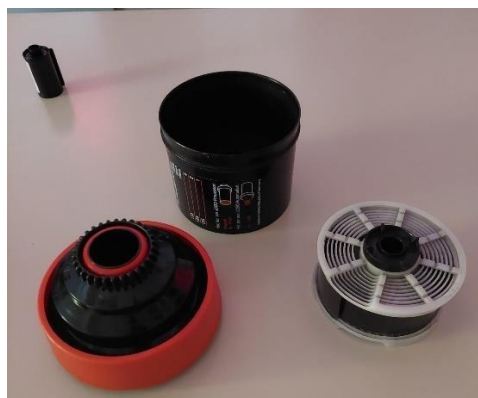
Slika 17. Posuda za razvijanje i spirala na kojoj je namotan snimljen film, izvor: autor
