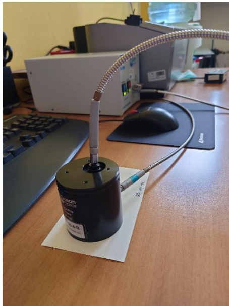
Slika 16 Spektrofotometar Ocean Optics USB 2000+
