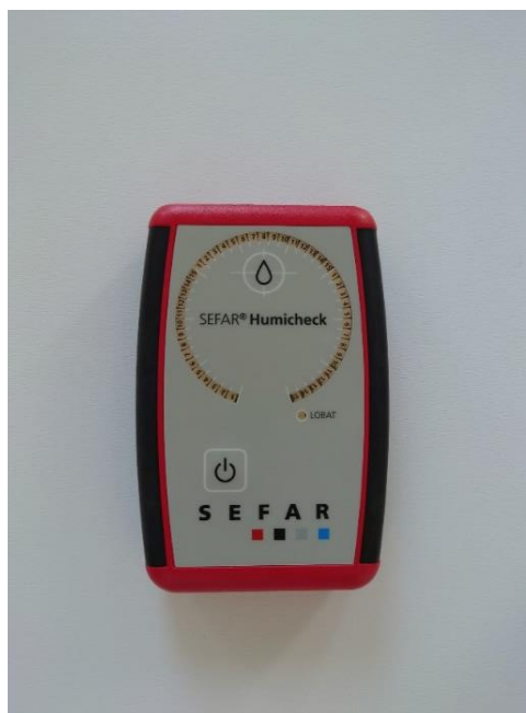
Slika 14 SEFAR Humicheck uređaj za mjerenje vlage
