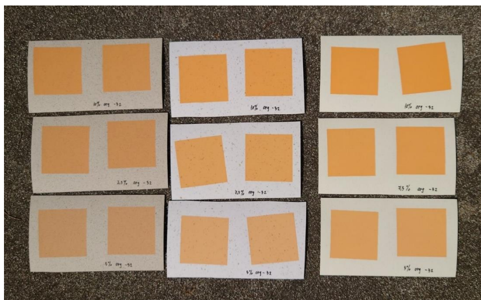
Slika 44 Otisci narančaste boje izrađeni tiskovnom formom linijature 32 lin/cm
