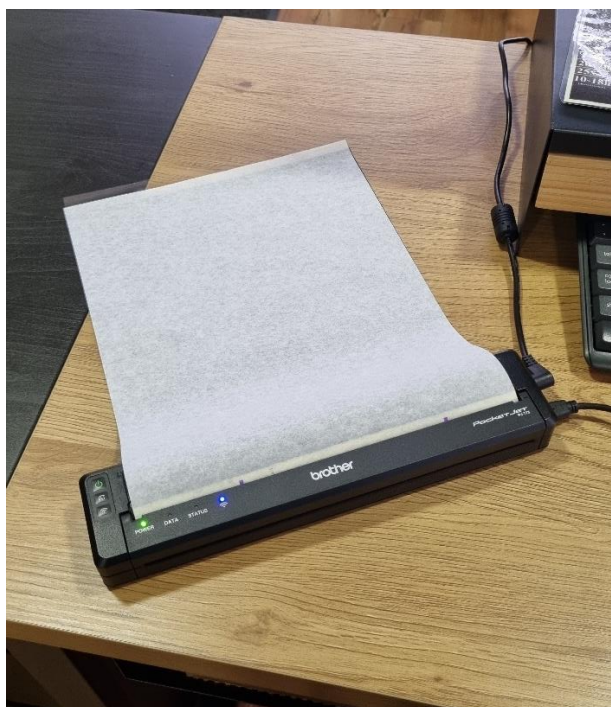
Slika 53. Termalni printer sa spremnim indigo papirom
