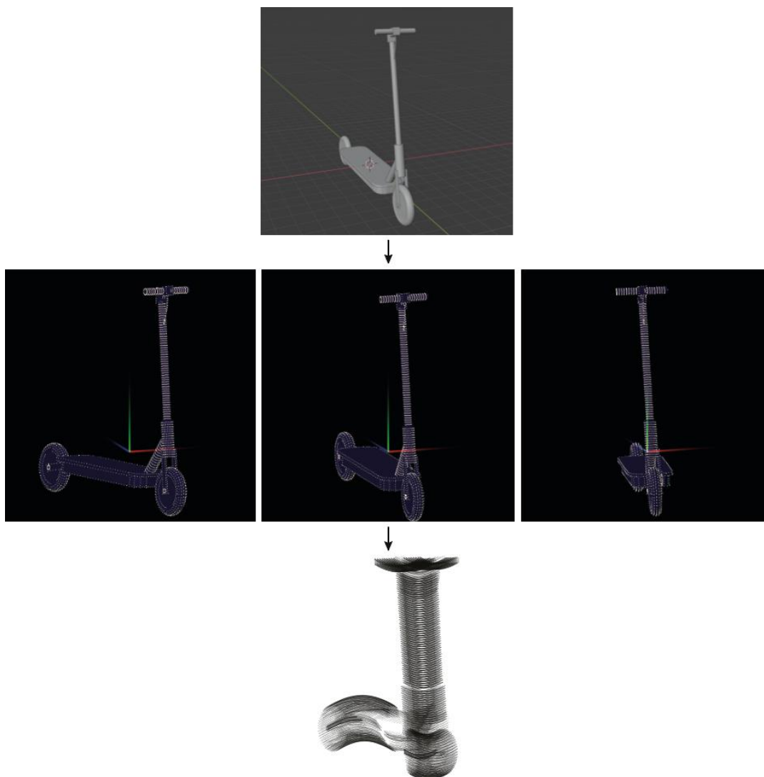
Slika 10. Postupak izrade 3D modela abrazijskog holograma
