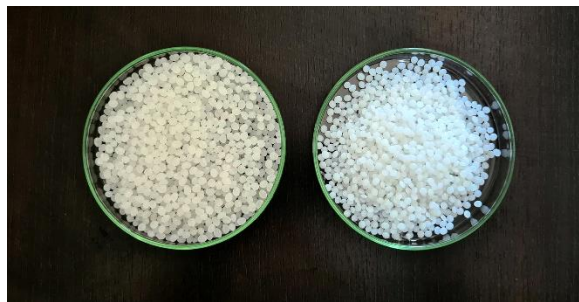
Slika 7. Granule PLA i PCL
