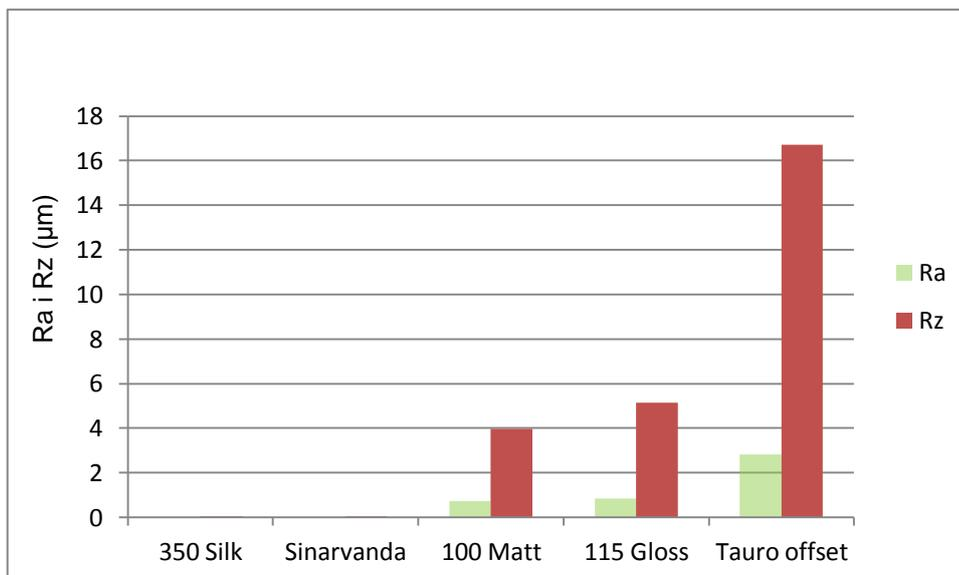
Slika 31. Stupčasti dijagram za hrapavost ispitivanih uzoraka
