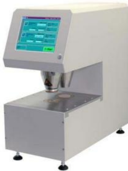
Slika 29. PTI-Line Bekk uređaj za određivanje glatкости
