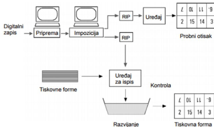
Slika 2. Radni tok Izrade tiskovnih formi CtP postupkom
