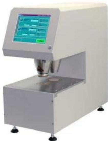
*Slika 29. PTI-Line Bekk uređaj za određivanje glatkosti*
