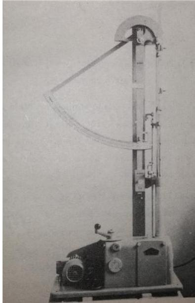
*Slika 18. Uređaj za određivanje otpornosti prema kidanju*
