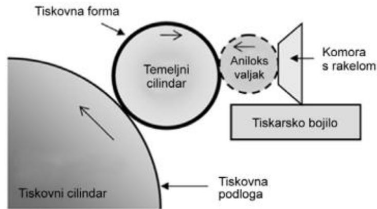
Slika 4. Princip rada fleksotiska
