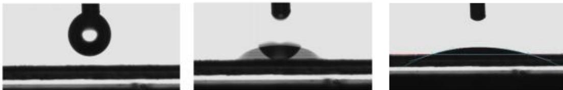
Slika 28. Izmjera kontaktnog kuta koristeći metodu kapanja
