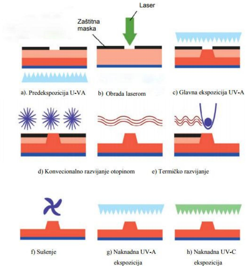
Slika 11. Faze izrade tiskovne forme digitalnim postupkom
