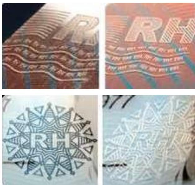
Slika 20 - Taktile laminacijske strukture na PC identifikacijskoj stranici putne isprave RH
