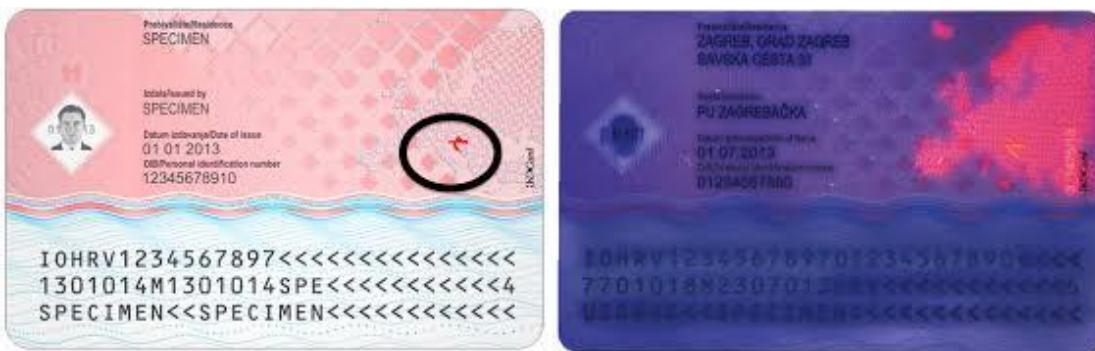
Slika 10 - Pozadinski tisk pod normalnim svjetлом (lijevo), Ista stranica pod UV svjetлом: – fluorescentna tinta (desno).
