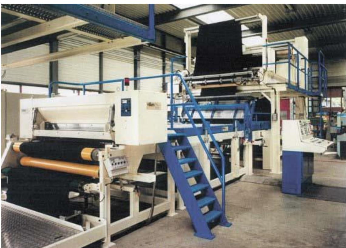
Slika 3 – Postrojenje za premazivanje ekstruzijom.
