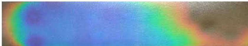
Slika 1. Izgled termokromne boje na bazi tekućih kristala kada je izložena temperaturi aktivacije (Izvor: https://eprints.grf.unizg.hr/3264/1/DB879_Penava_Ivan.pdf )
