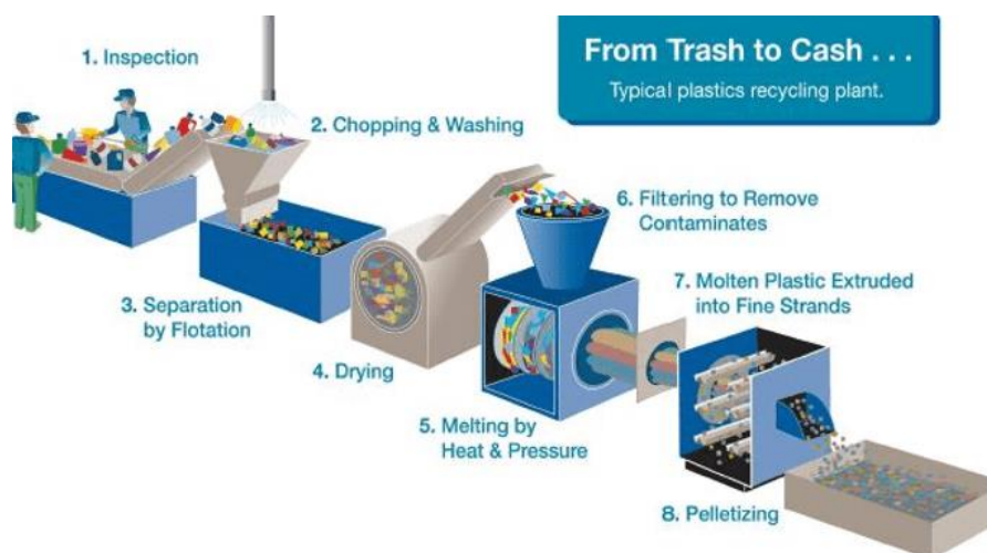
Slika 15. Postupak recikliranja plastike
