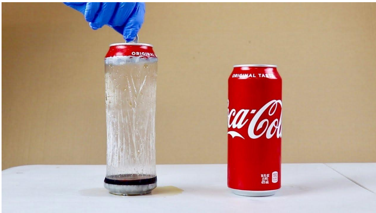
Slika 2. Plastični film unutar aluminijske limenke bifenol-A
