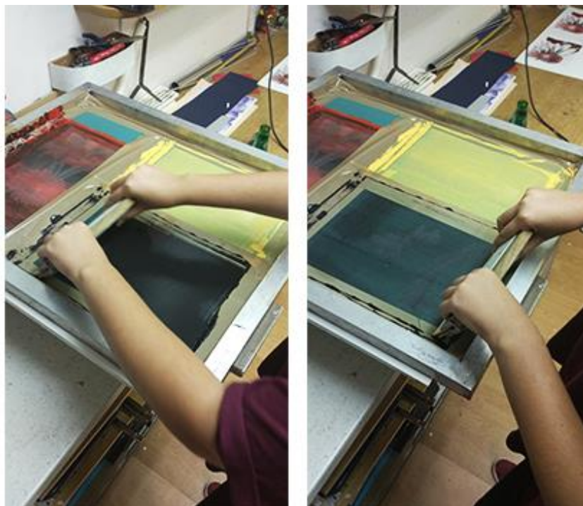
Slika 19. Proces otiskivanja u sitotisku s dvije boje (crna i srebrna)
