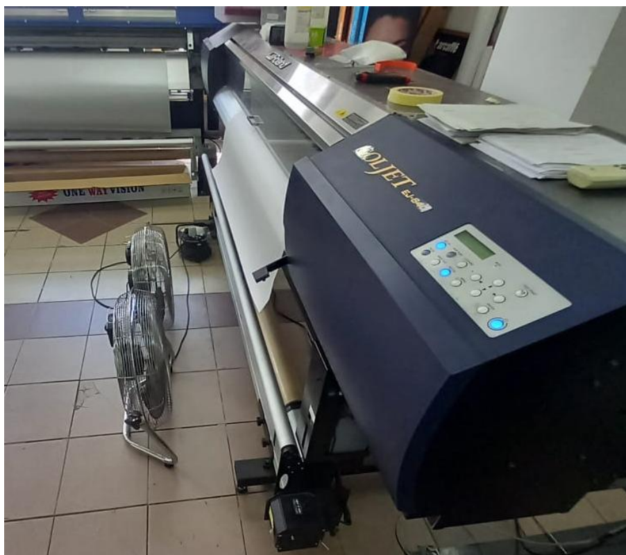
Slika 19. Regulacija temperature uz pomoć ventilatora
