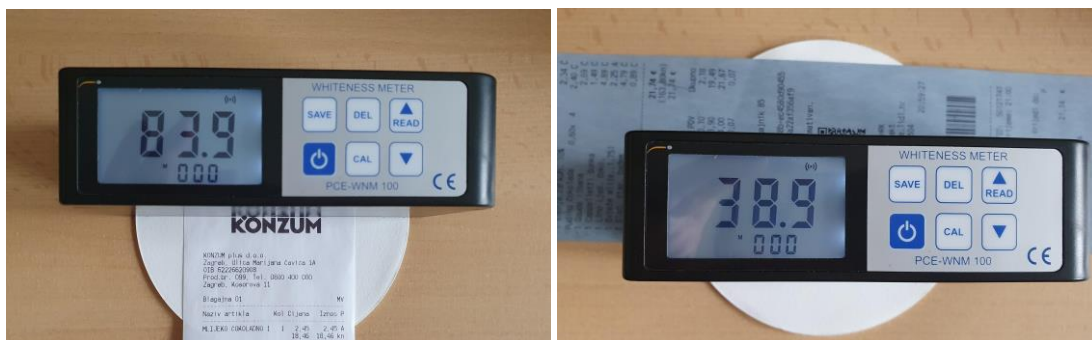
Slika 14. Mjerenje svjetline uzoraka
