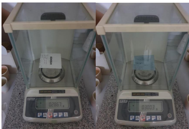
Slika 10. Vaganje uzoraka za određivanje gramature papira
