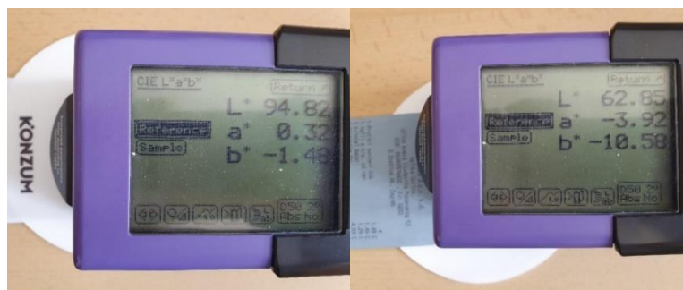
Slika 13. Mjerenje CIE L*a*b* vrijednosti uzoraka
