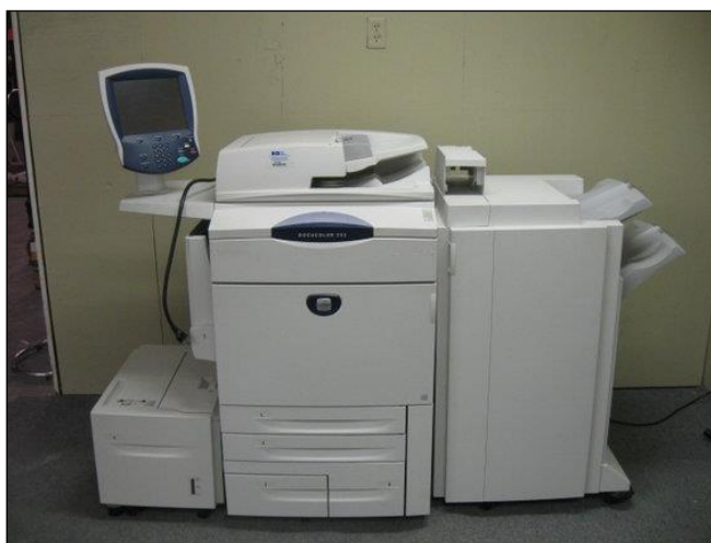
Slika 38. Xerox DocuColor 252 digitalni tiskarski stroj
