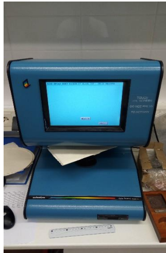
Slika 9. Spektrofotometar- Technidyne Color Touch 2
