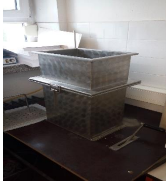
Slika 7. Ručni stroj za izradu listova
