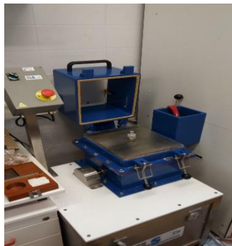
Slika 5. Uređaj za uklanjanje ljepljivih čestica
