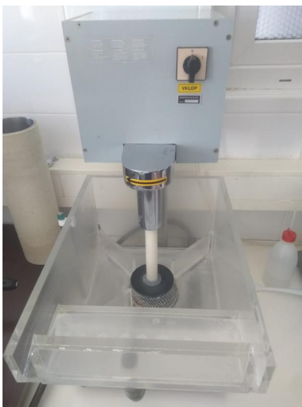
Slika 7: Prikaz flotacijske ćelije
