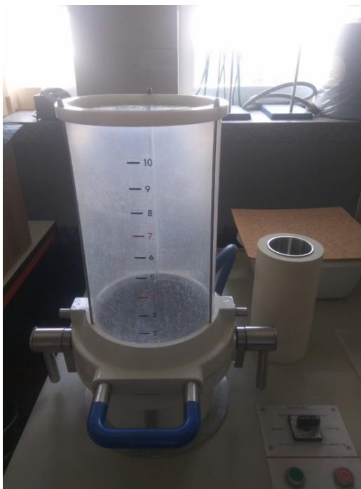
Slika 8: Prikaz uređaja za automatsku izradu papira
