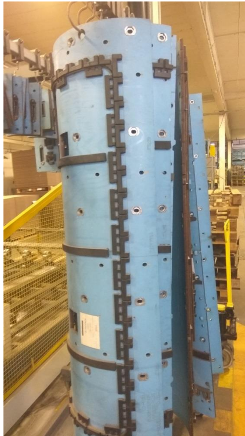
Slika 6. - Štanca za rotacijsko rezanje (osobna fotografija)
