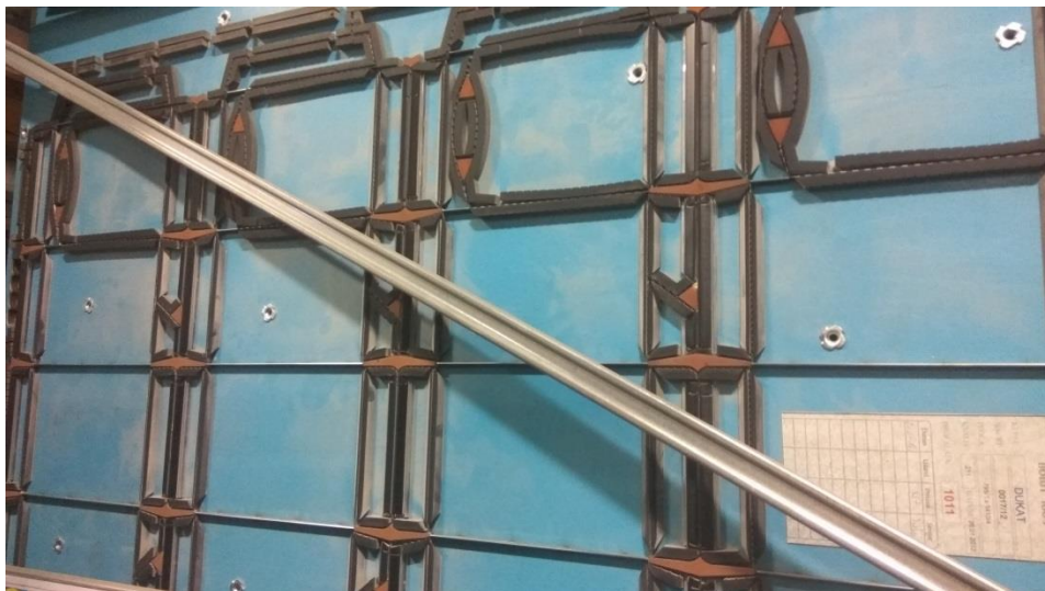
Slika 4. - Štanca za plošno rezanje (osobna fotografija)
