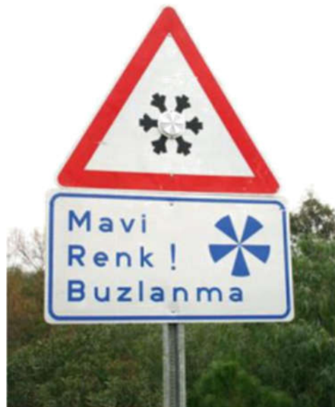
Slika 1.: Termokromni pokazatelj rizika od zaleđivanja ceste [2]
