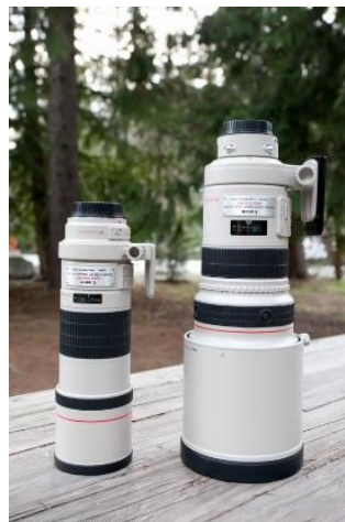
Slika 3: Usporedba objektiva iste žarišne daljine s maksimalnim otvorom blende f4 (lijevo) i f2.8 (desno) (Izvor: http://dancarrphotography.com/blog/wp-content/uploads/2010/07/100419_9104_dancarr.jpg )
