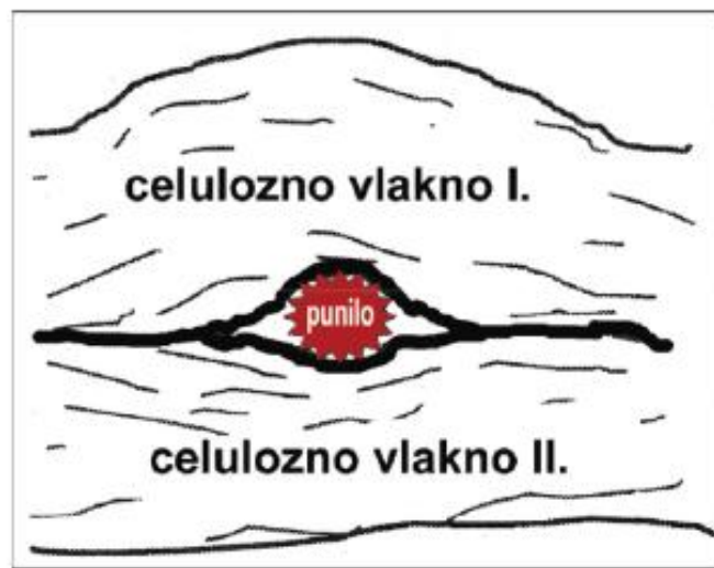
Slika 12. Čestice punila smještene između vlakana [10]
