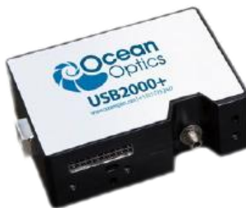
Slika 14. USB2000+ spektrometar raspona od 200 - 1100 nm, optičke rezolucije od 0,3 - 10 nm i vremenom integracije 1ms – 65s
