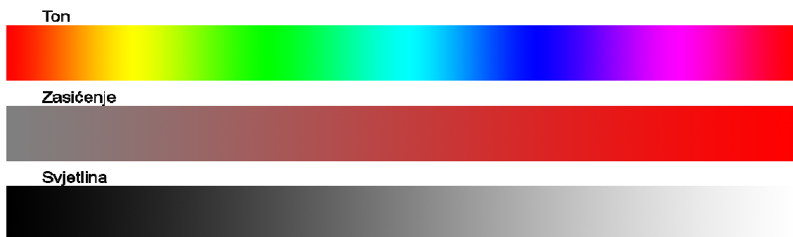
Slika 5. Ton, zasićenje i svjetlina boje
