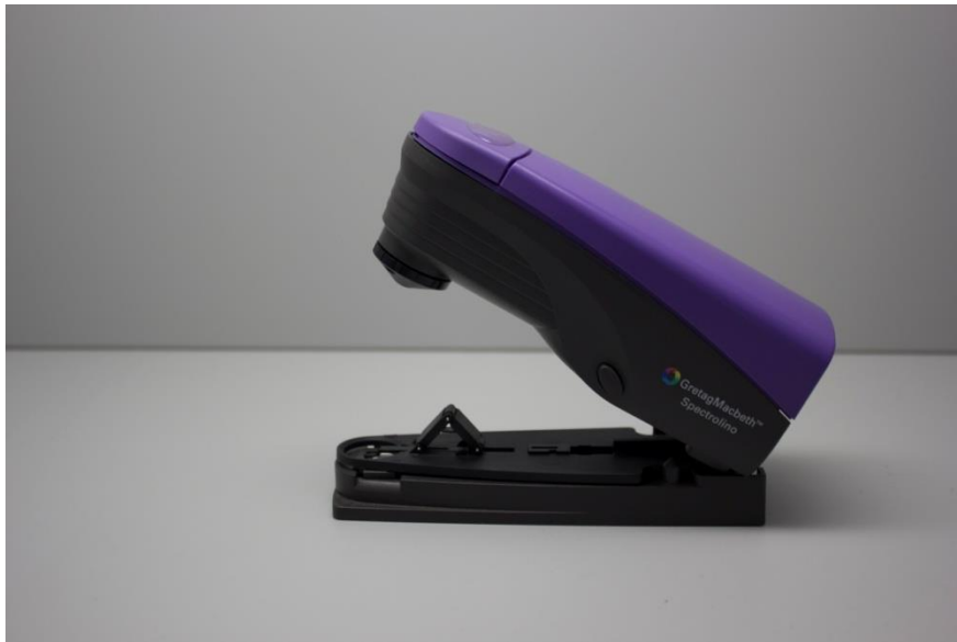
Slika 14. Spektrofotometar: GretagMacbeth Spectrolino
