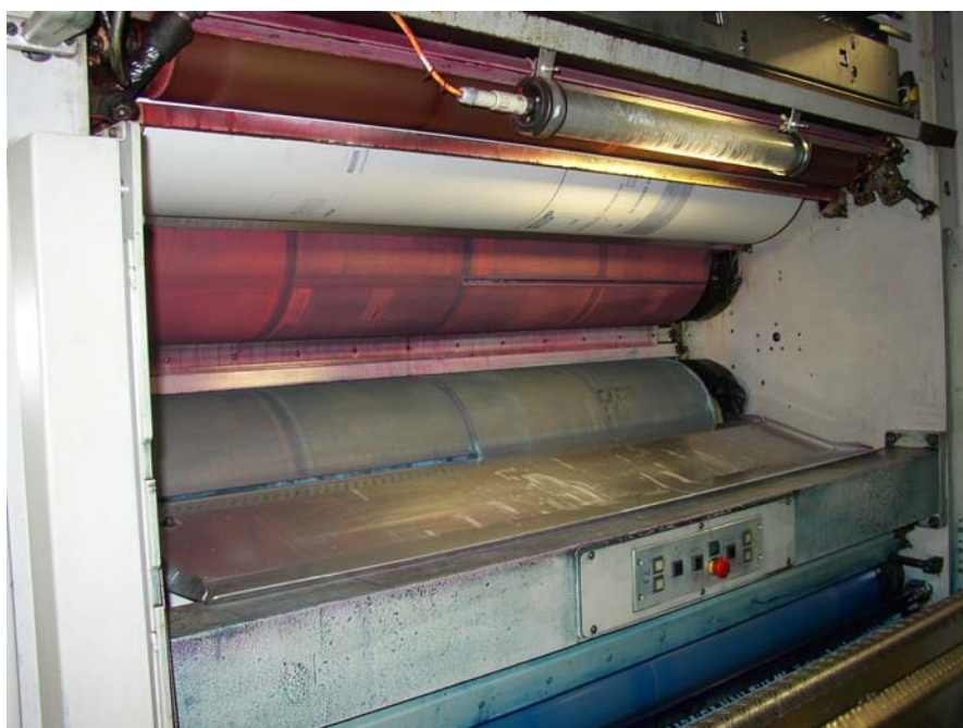
Fig. 21. Prikaz pločnog cilindra s pločama i gumi cilindra s montioranim gumenim navlakama
