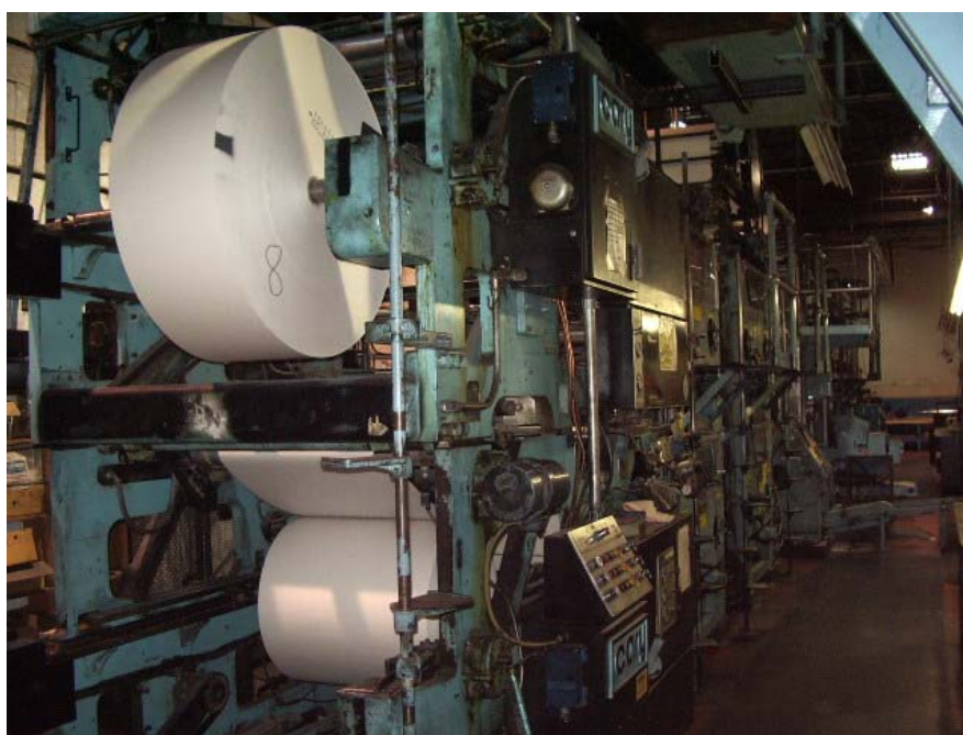
Fig. 10. Nosač rola stroja GOSS Urbanite
