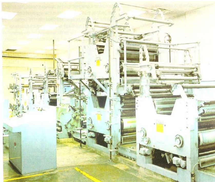
Fig. 9. Offsetna rotacija GOSS Urbanite
