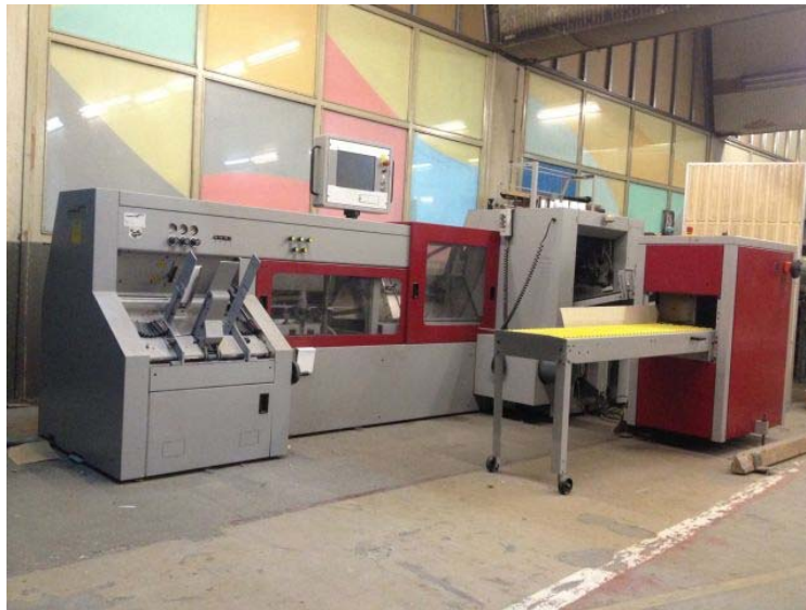
Slika 3. Stroj za šivanje knjižnih araka koncem - Ventura
