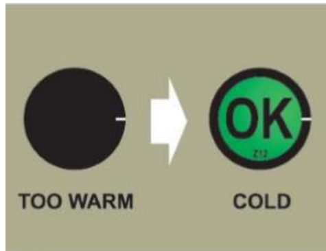
Slika 6. Indikator za toplinu pokazuje zeleni krug sa ispisanim OK na desnom zacrnjenom krugu ako je proizvod na polici, u skladištu ili transportu čuvan na odgovarajućoj temperaturi. U suprotnom dolazi do obojenja lijevog zacrnjenog kruga.
