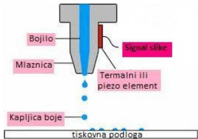
Slika 8. Princip rada diskontinuiranog inkjeta
