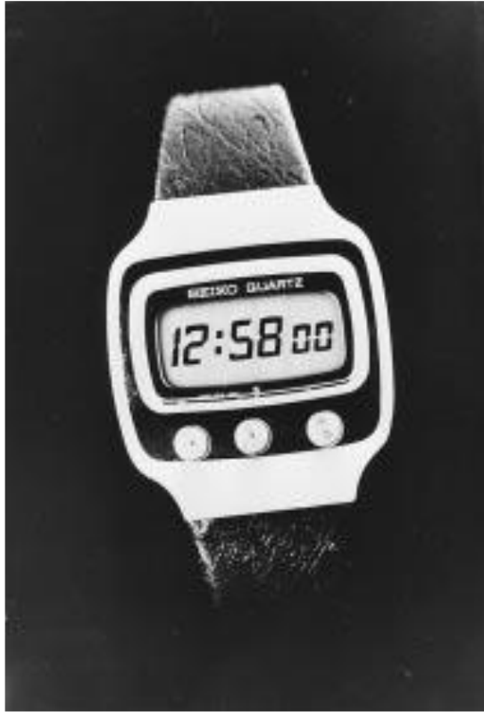
Slika 5. Prvi proizvod TN principa: digitalni sat
