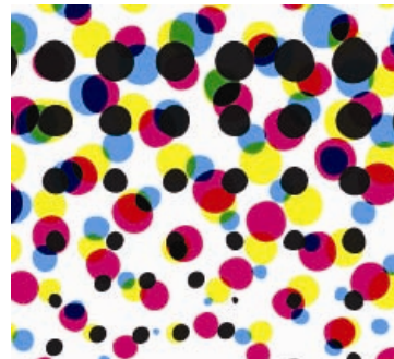
Slika 10. Dobivanje reprodukcije kod hibridnog sustava rastriranja
