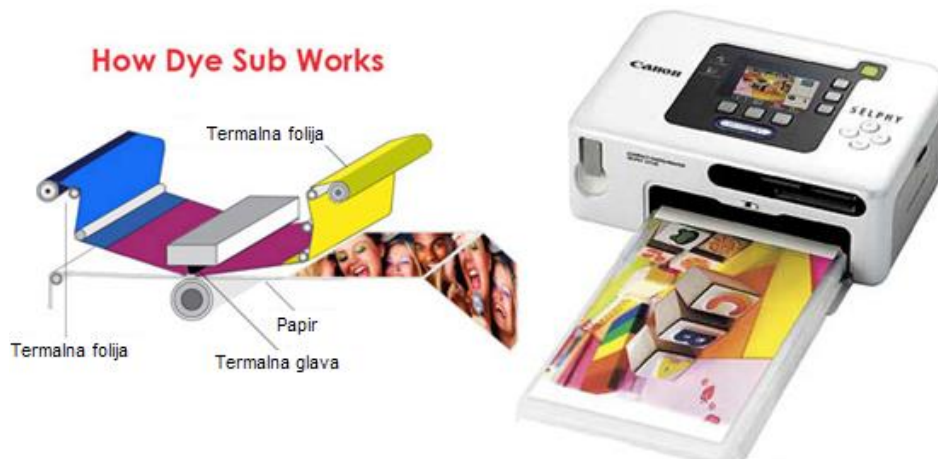
Slika 9: Princip rada kod sublimacijskog pisača
