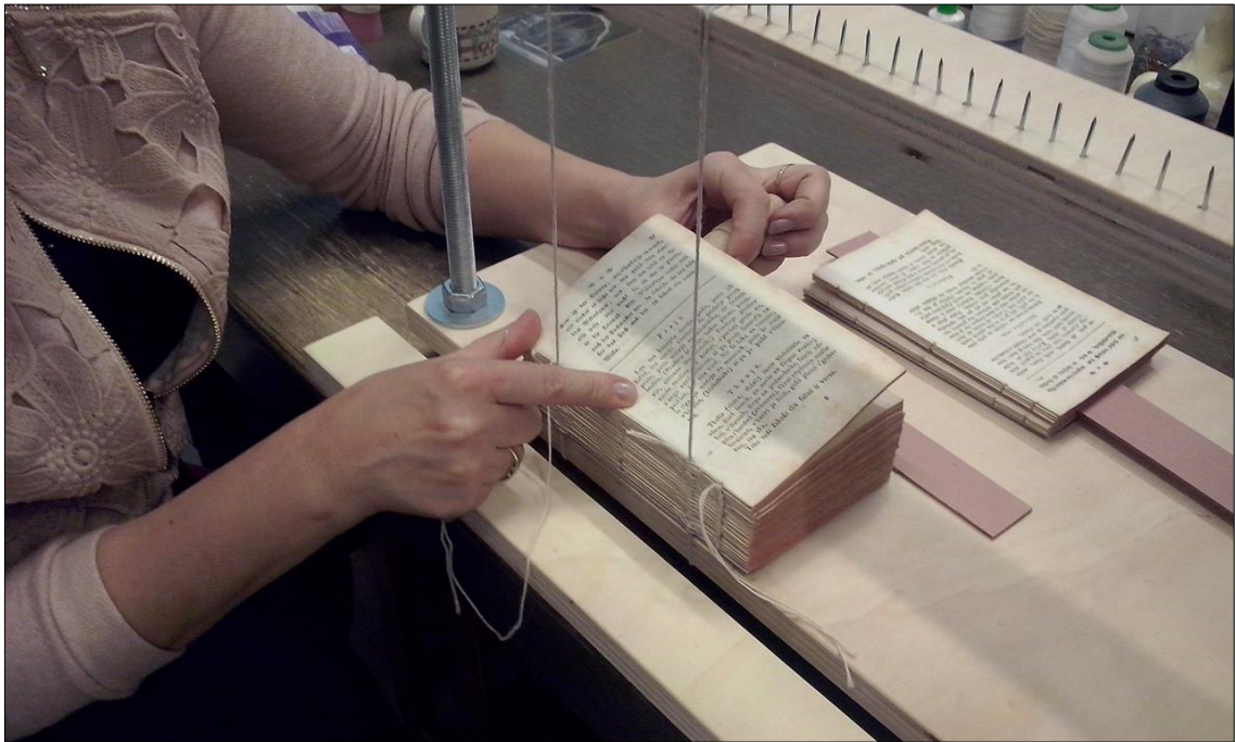
Slika 40. Šivanje na šivaljki, na dvije upiljene vezice
