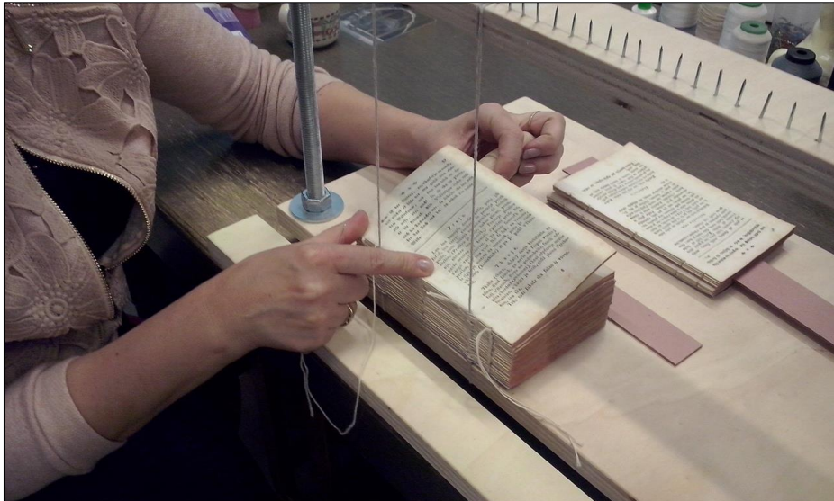
Slika 19. Ručno šivanje na šivaljki [ 3 ] na dvije upiljene vezice
