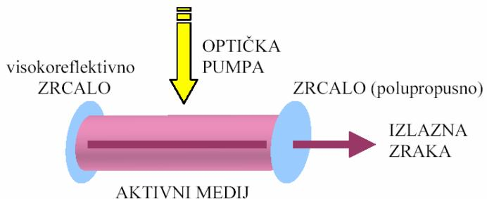
*Slika 14. Shematski prikaz osnovnih dijelova lasera [12]*
