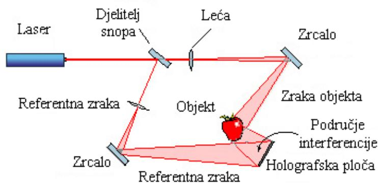
Slika 9. Nastanak holograma realnog objekta na holografskoj ploči. Objektni i referentni val prilaze ploči s iste strane [9]
