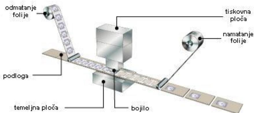
Slika 16. Otiskivanje pritiskom ploče o ploču [16.]
