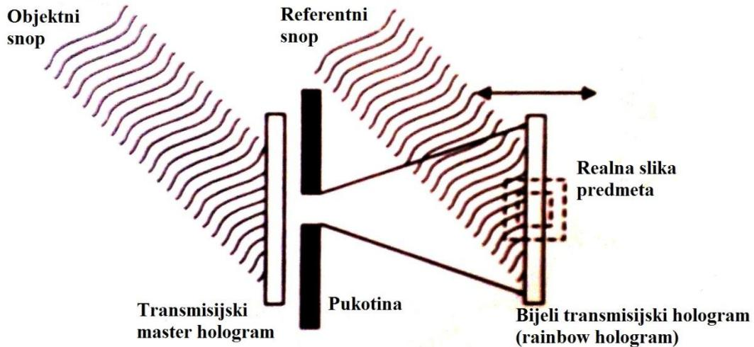
*Slika 15. Shematski prikaz dobivanja bijelog transmisijskog holograma od transmisijskog master holograma [13]*
