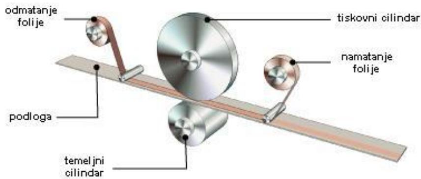
Slika 17. Otiskivanje sistemom valjak o valjak [16.]
