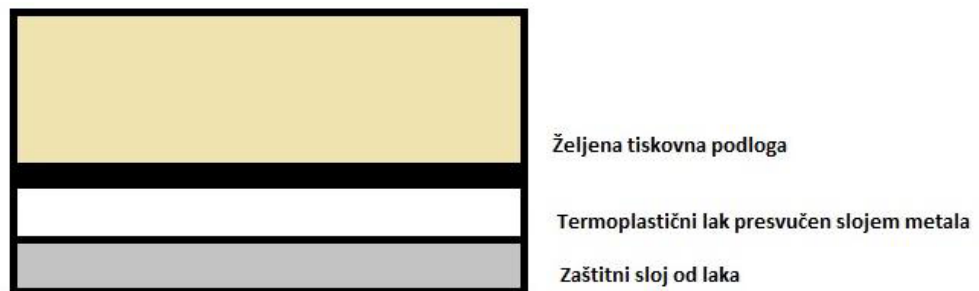
Slika 19. Prijenos na željenu tiskovnu podlogu [16]
