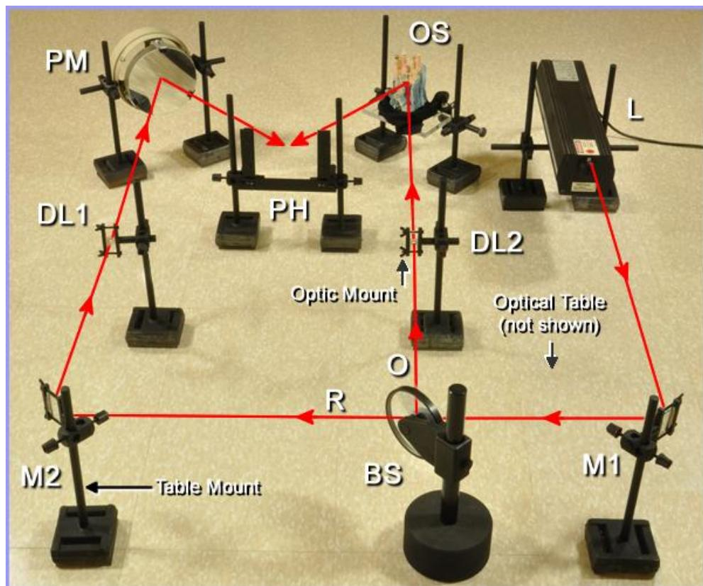
Slika 13. Osnovna holografska postava: L – laser, BS – djelitelj snopa, M1 i M2 – zrcala, DL1 i DL2 – divergentne leće, PM – parabolično zrcalo, OS – objekt snimanja, PH – fotografска ploča, Table Mount/Optic Mount – držači, Optical Table – optički stol
