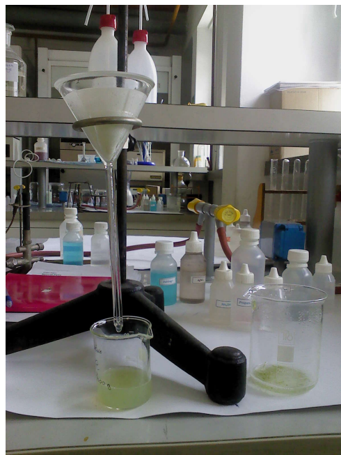
Slika 9: Filtracija nakon ekstrakcije
