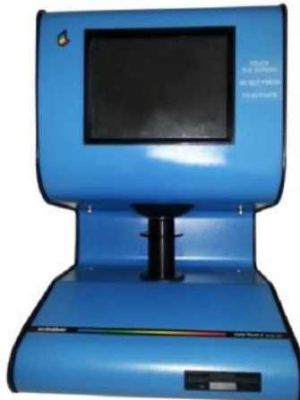
Slika 10. Uređaj za mjerenje svjetline papira Colour Touch 2
