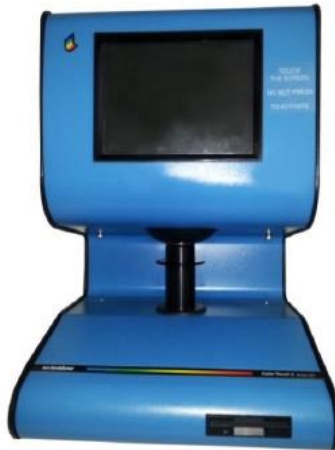
Slika 10. Uređaj za mjerenje svjetline papira Colour Touch 2
