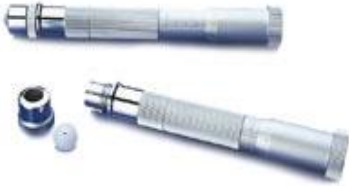
Slika 12. Pipete za doziranje precizne količine boje i ulja
