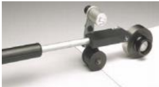
Slika 13. IGT uređaj za određivanje stupnja prašenja premaza (prikupljanje nedovoljno vezanih čestica s površine premaza)
