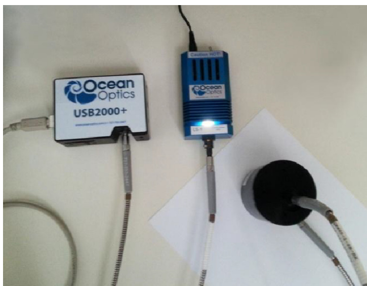
Slika 8. Mjerenje kolorimetrijskih promjena pomoću spektrofotometra Ocean OpticsUSB 2000+
